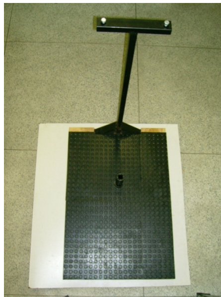
Figura 32 - Vista anterior e superior da base de sustentação coberta com a placa compensada de madeira e com placas antiderrapantes.
