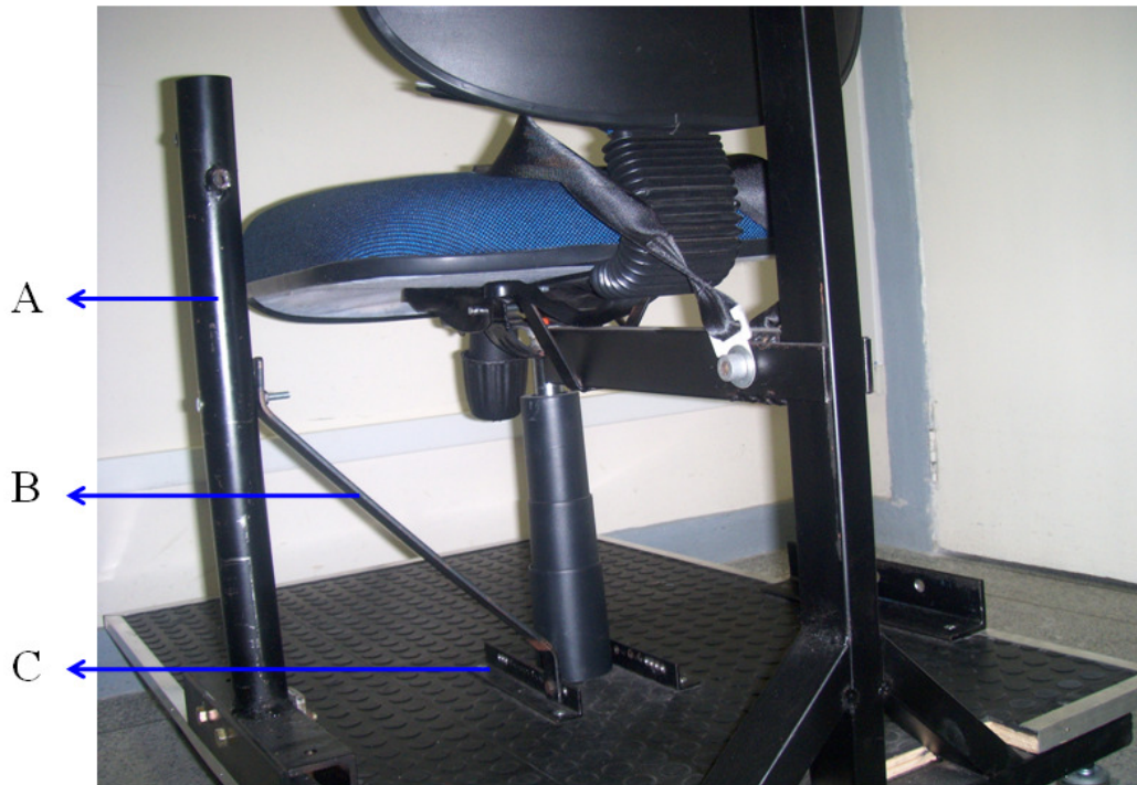
Figura 40 - Vista posterior e lateral esquerda apresentando: (A) tubo do DME fixado na cantoneira lateral, (B) haste de ferro chato e (C) cantoneira central esquerda.
