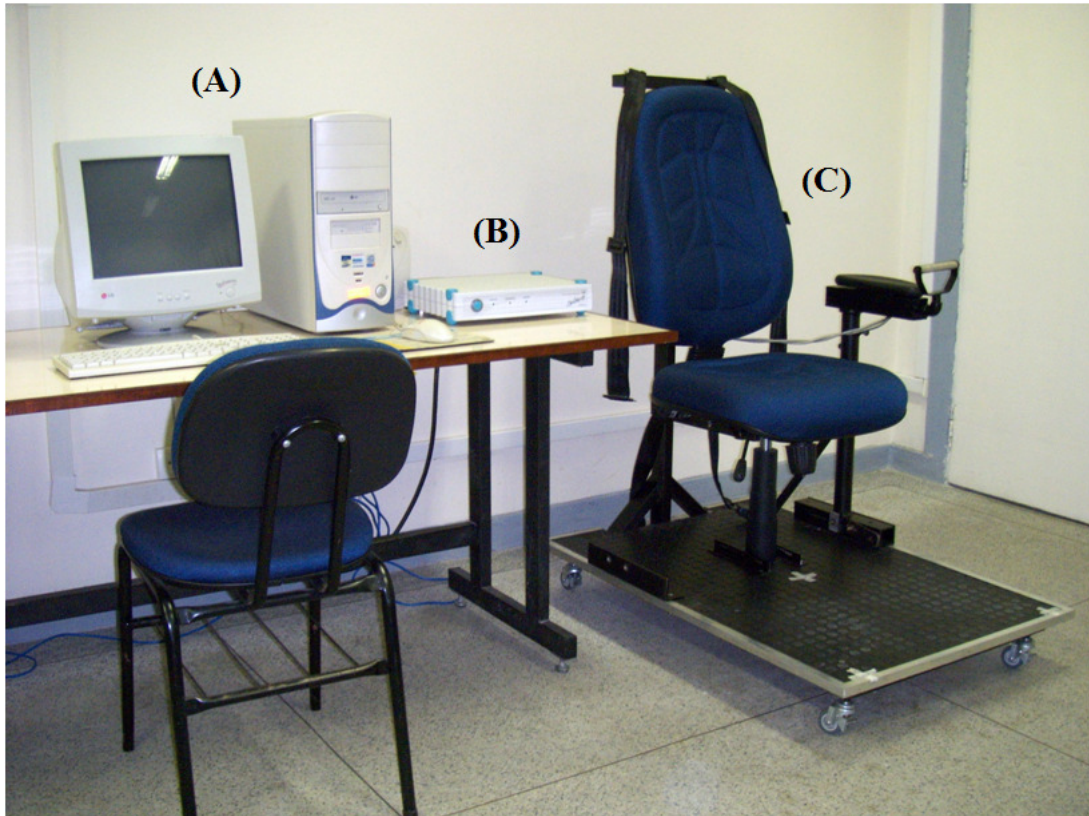
Figura 43 - Sistema de aquisição: (A) computador, (B) sistema de aquisição e condicionamento de sinais modelo SPIDER 8 e (C) estação de medição de força.
