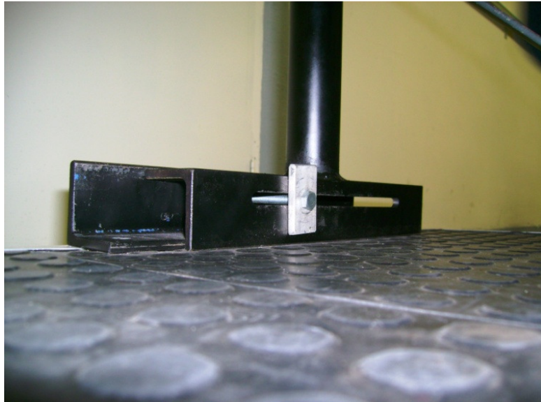
Figura 37 - Detalhe da cantoneira fixada na base da EMF.
