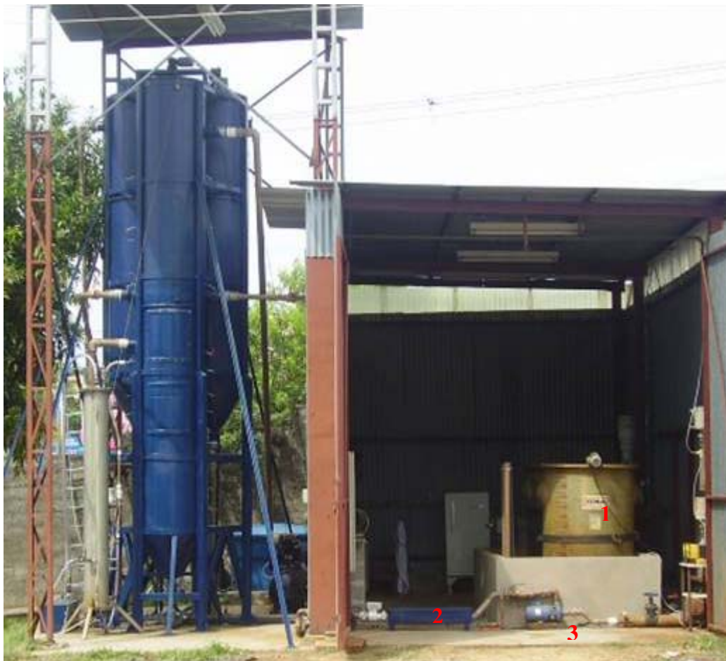
Figura 4.10 - Fotografia frontal da instalação piloto ilustrando o reator principal e parte dos acessórios da unidade
