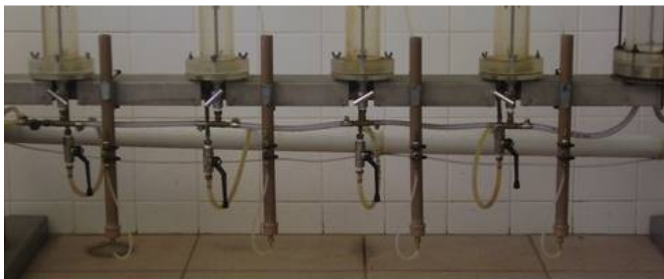
Figura 4.4 - Fotografia dos filtros em escala de bancada acoplados ao equipamento de Flotateste para ensaios preliminares de floculação/flotação e filtração
