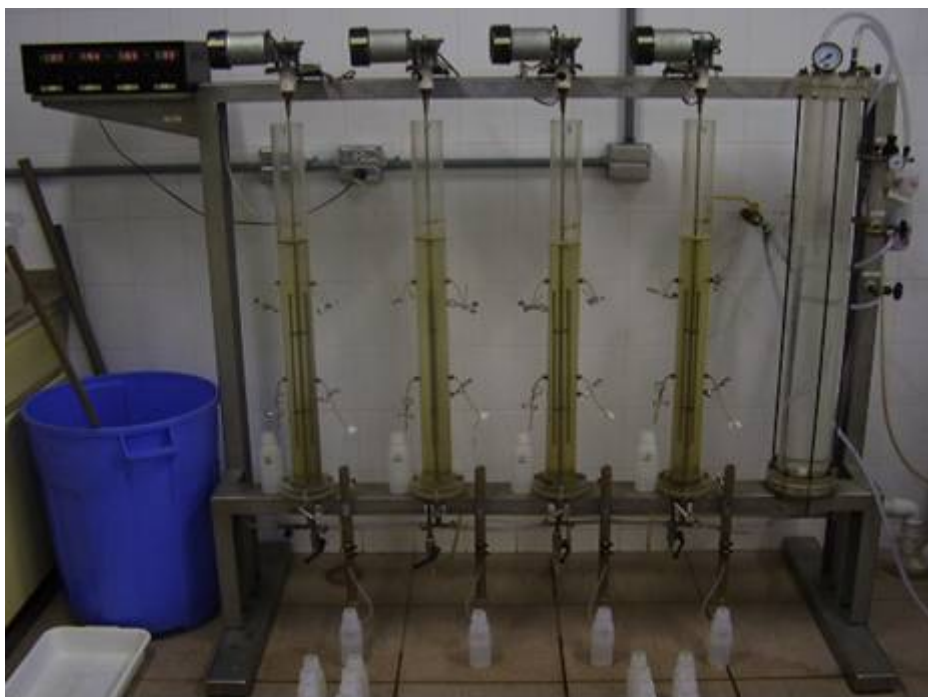
Figura 4.3 - Fotografia do Equipamento de Flotatestes desenvolvido no Departamento de Hidráulica e Saneamento da Escola de Engenharia de São Carlos – SP e unidades de filtração em areia acopladas às câmaras de flocculação/flotação
