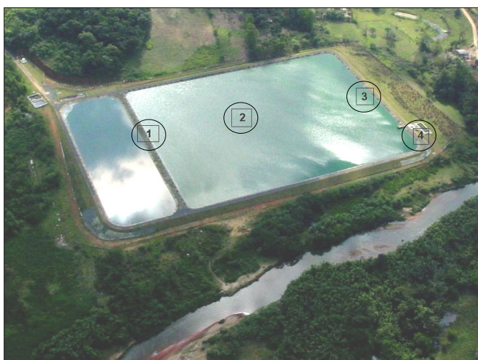
Figura 13 – Pontos de coleta (1, 2 e 3) na lagoa facultativa da Estação de Tratamento de Esgoto de Cajati e (4) na área de lançamento para o rio, no tanque de cloração. Foto: Mario D. Domingues.
