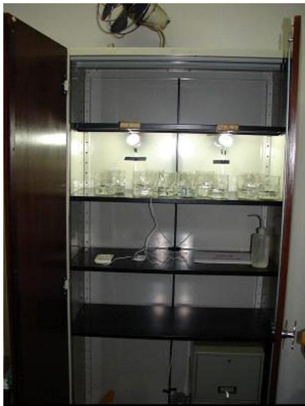
Figura 3.11 - Estrutura (armário) usada para a germinação das sementes (controle de temperatura da água entre 20 °C e 24 °C)
