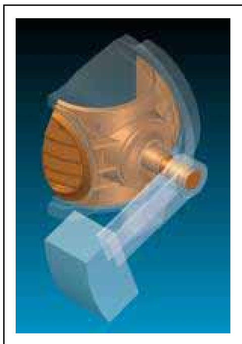
Figura 1.15 – Válvula Esférica com Fechamento por Contra-Pesos (Voith Siemens)
