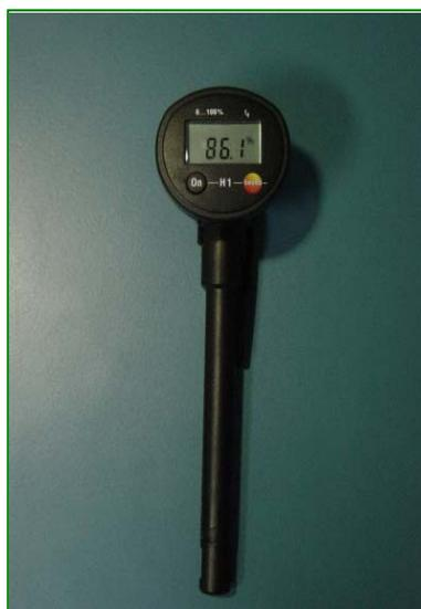
**Figura 2** - Psicrômetro digital portátil modelo 605-H1 (Testo® - Alemanha)
