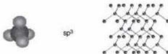
Figura 2\_ Estrutura do diamante, mostrando hibridização  $sp^3$ .
