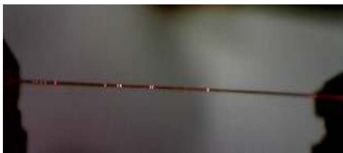
Figura 5.20 – Espalhamentos localizados (pontos brilhantes) ao longo de uma PCF de núcleo polimérico dopado com pontos quânticos indicando a possível existência de bolhas de ar.
