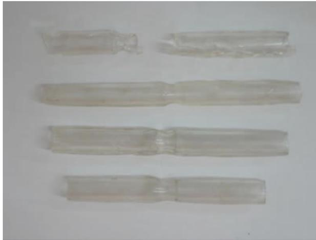
**Figura 7.6.** Representação dos tubos estenosados de silicone (Sylgard 184, Dow Corning).
