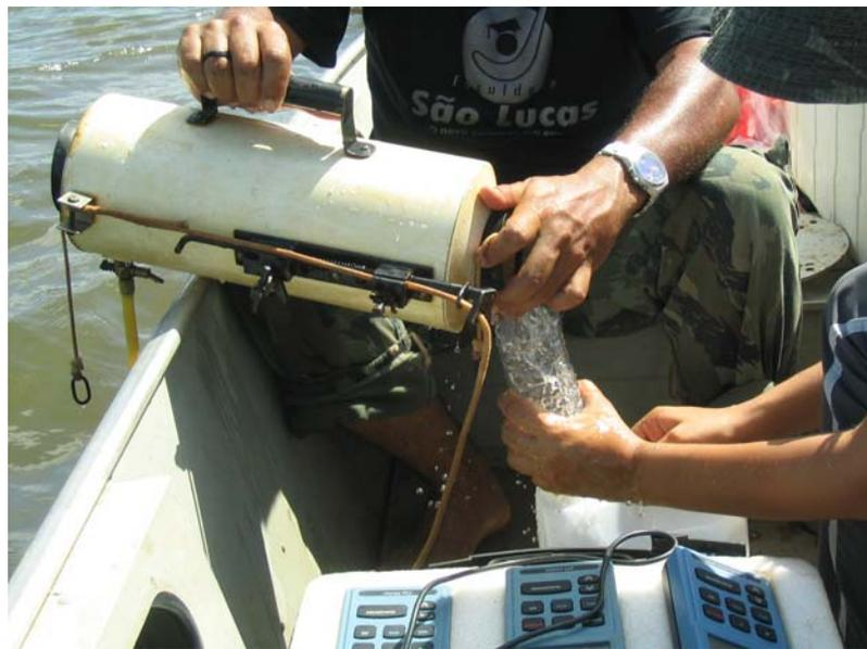
Figura 3: Coleta de água no Reservatório de Samuel (RO)/2007 para a obtenção do material particulado em suspensão. Foto: pela autora.
