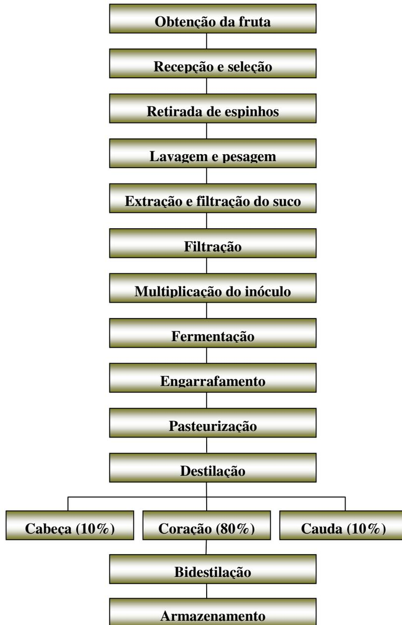
Figura 3.1 - Etapas dos experimentos realizadas na elaboração da bebida fermentada e destilada respectivamente
