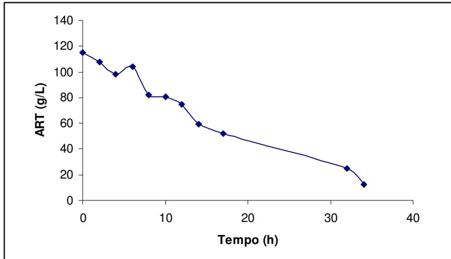
Figura 4.3 – Comportamento dos valores médios da concentração do ART durante a fermentação alcoólica
