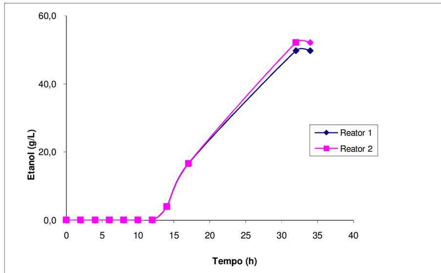
Figura 4.2 – Curva de produção de etanol durante a fermentação alcoólica
