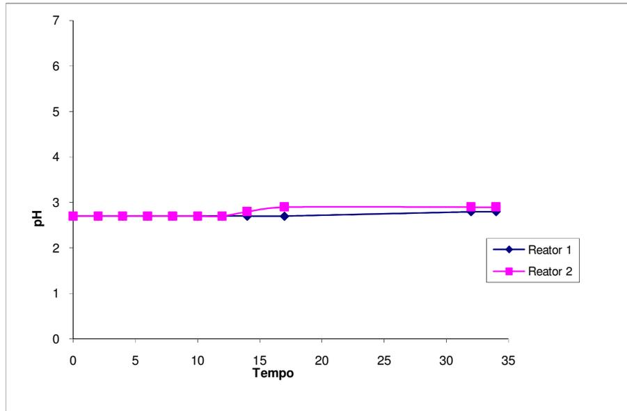
Figura 4.6 – Comportamento do pH durante a fermentação alcoólica
