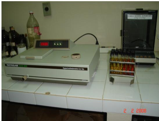
Figura 3.3 – Espectrofotômetro utilizado na leitura da absorvância para determinação dos açúcares redutores totais (ART). Fonte: Foto de A. S. ROCHA
