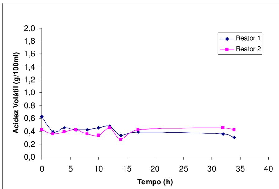
Figura 4.7 – Comportamento da acidez volátil durante a fermentação alcoólica
