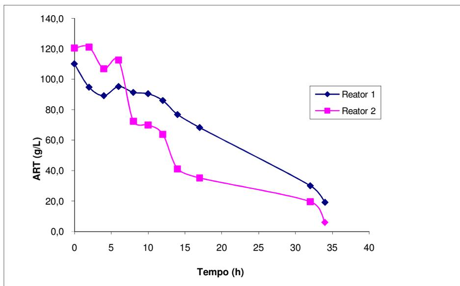
Figura 4.1 – Comportamento do substrato (ART) durante a fermentação alcoólica
