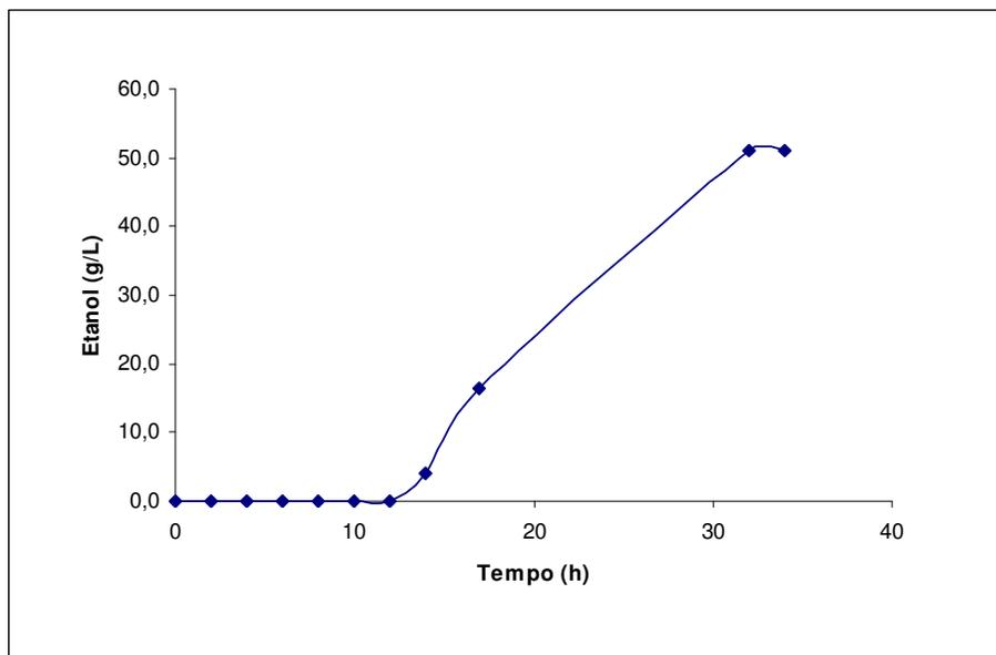
Figura 4.4 – Comportamento dos valores médios do etanol durante a fermentação alcoólica
