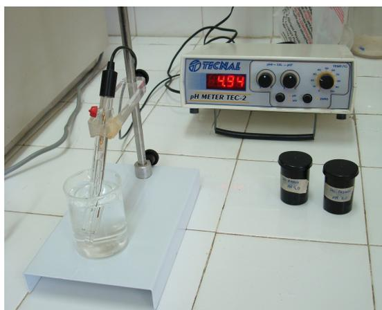
Figura 3.4 – pHmetro digital (TECNAL modelo: TEC-2). Fonte: Foto de A. S. ROCHA
