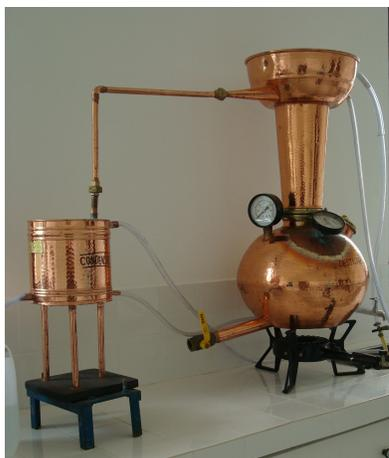
Figura 3.6 – Alambique de cobre utilizado na destilação da aguardente do figo-da-índia. Fonte: Foto de A. S. ROCHA
