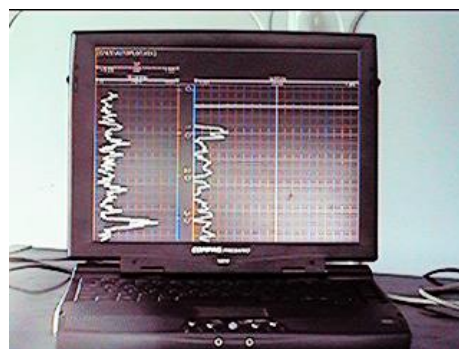
Foto 2 – Equipamento portátil de perfilagem geofísica. Detalhe do Notebook que apresenta a leitura gerada na sonda perfiladora.
