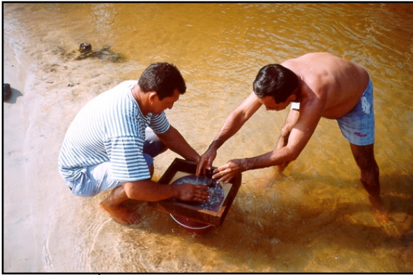
Figura 7 - À esquerda, coleta de sedimentos no igarapé do Cândido (ponto 12), à jusante de áreas de recreação (balneários); à direita, peneiramento de sedimentos coletados no igarapé Água Branca (ponto 07), afluente do rio Preto da Eva.
