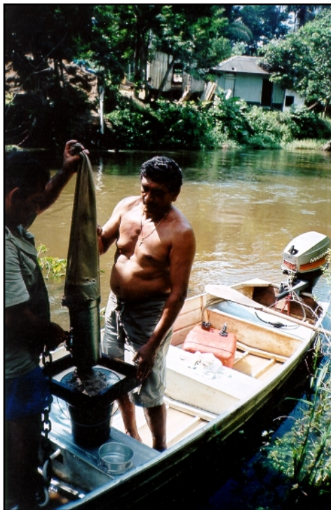
Figura 8 – Peneiramento de sedimentos coletados com amostrador de fundo no canal do rio Preto da Eva (ponto 20)
