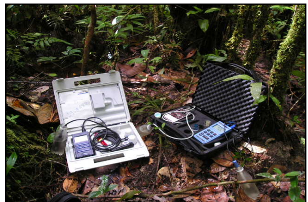
Figura 10 – Aparelhos para medição de pH, oxigênio dissolvido e condutividade elétrica dos corpos d'água amostrados
