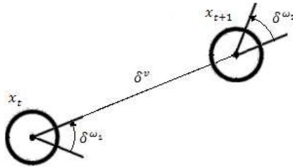
Figura 4.13 - Deslocamentos realizados durante a movimentação.
