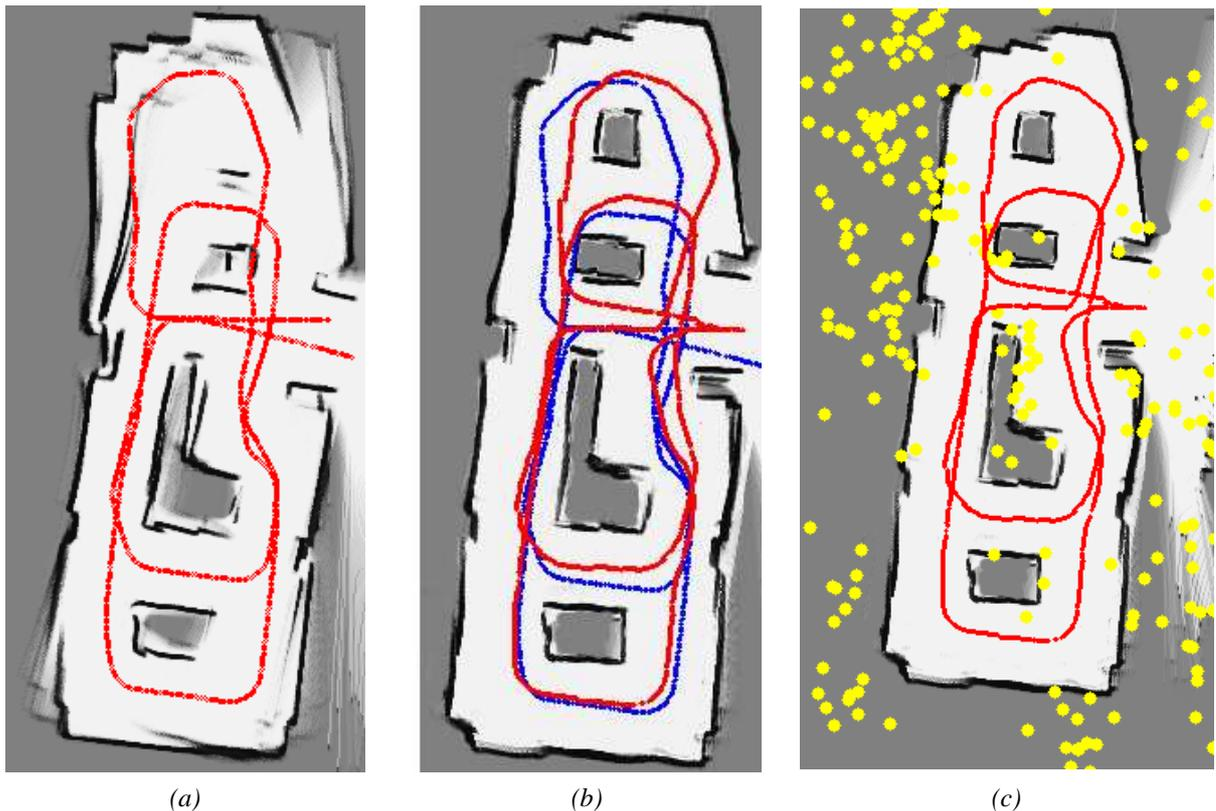
Figura 5.23 - Localização e mapeamento no segundo percurso real (laser).
