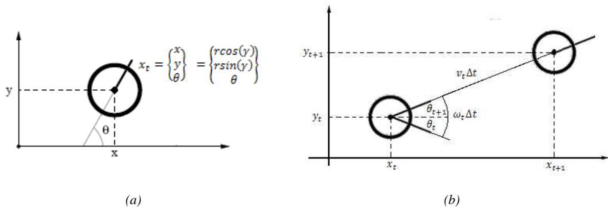
Figura 4.12 - Modelo de odometria. (a) Estado de localização (b) Modelo de movimentação
