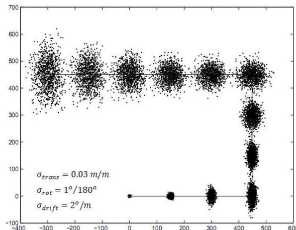
Figura 2.2 - Aumento de incerteza em um Filtro de Partículas. O robô começa em (0,0) e segue até (-300, 450), com erros gaussianos de média  $\mu = 0$  e desvios padrão  $\sigma$  distintos para cada tipo de deslocamento.
