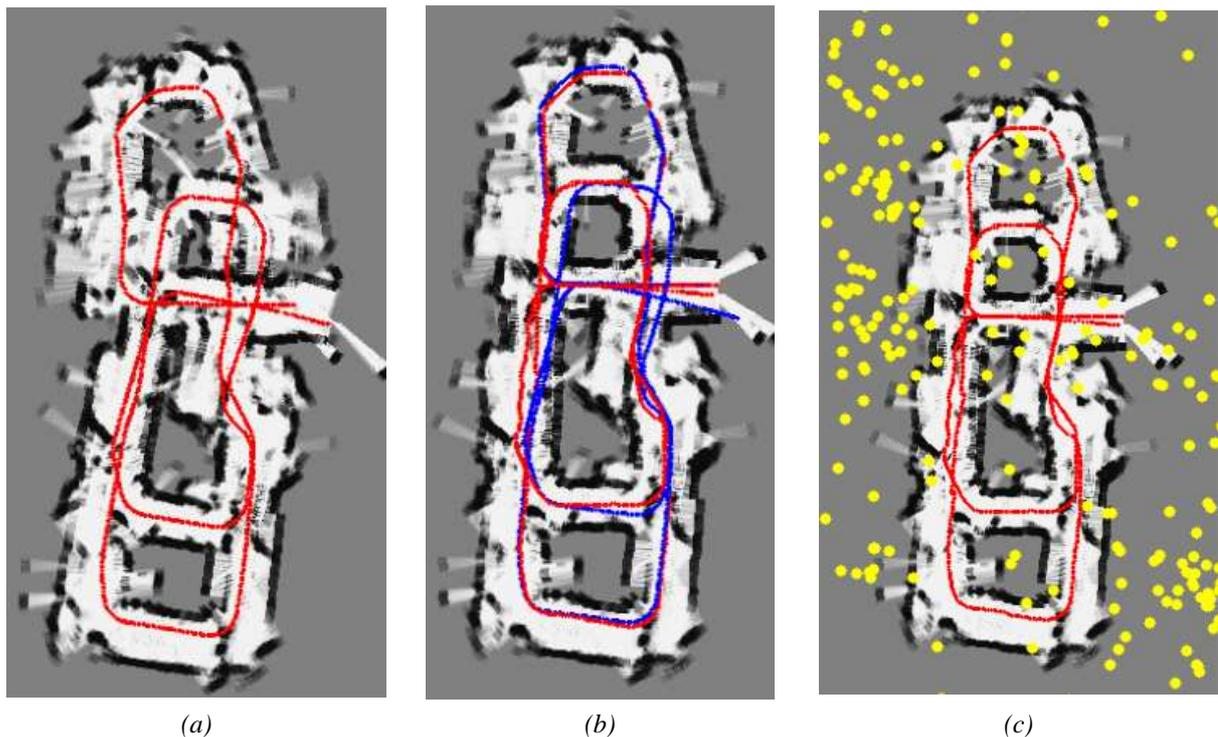
Figura 5.22 - Localização e mapeamento no segundo percurso real (sonar).
