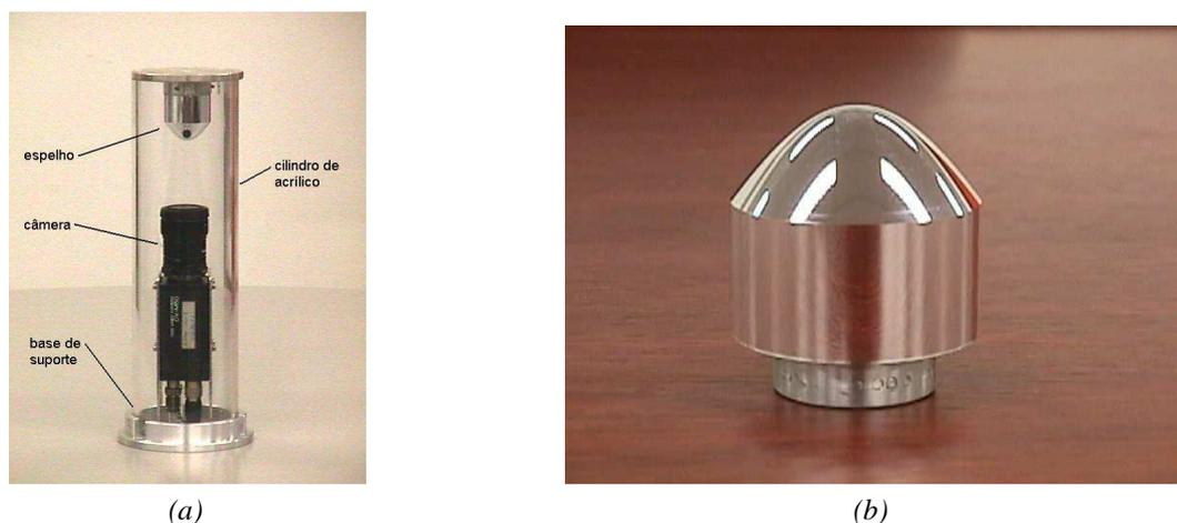
Figura 5.13 - Sistema de visão omnidirecional (Grassi Jr., Okamoto Jr.; 2006).
