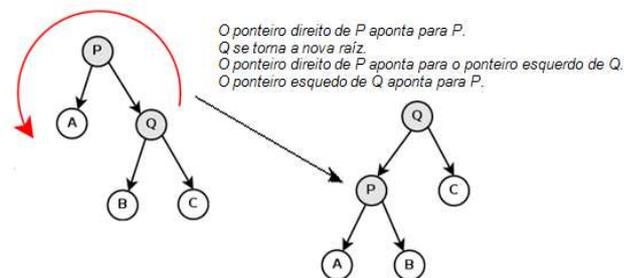
Figura 4.9 - Rotação de nós para a esquerda.
