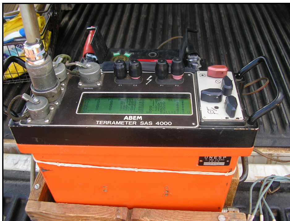
Foto 4.1: Equipamento Terrameter SAS 4000 utilizado nos ensaios
