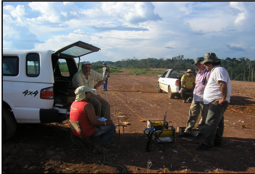
Foto 5.1: Execução da SEV1 sobre uma célula de resíduos
