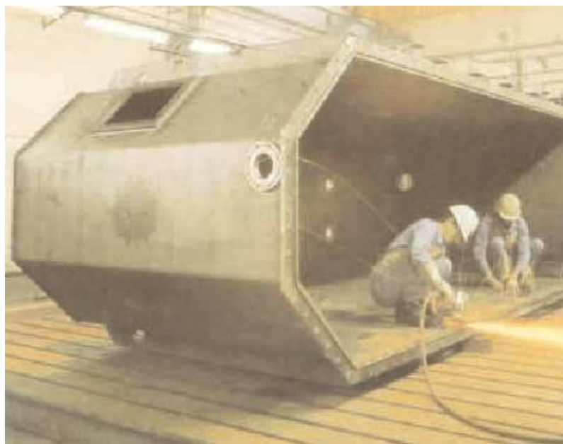
Figura 1.2: Tanque de um transformador
