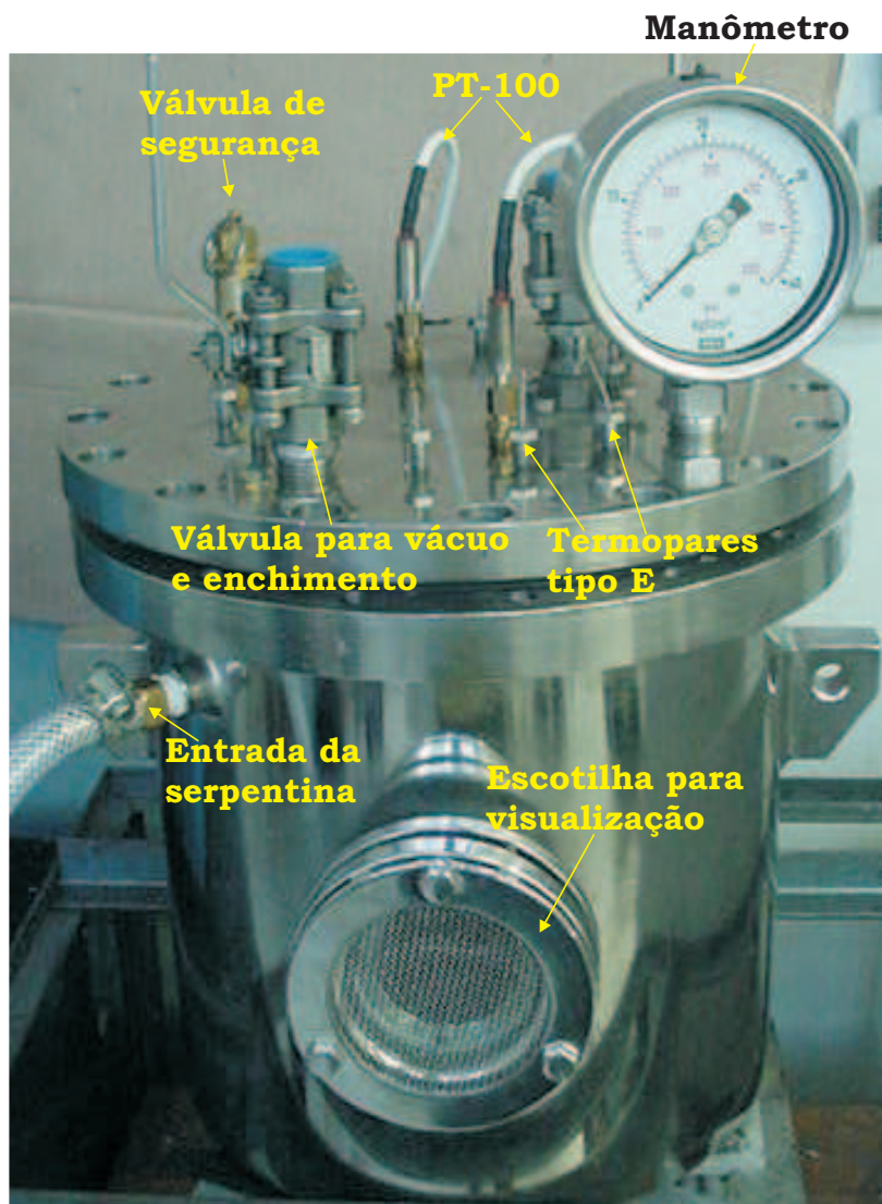
Figura 3.2: Fotografia da câmara de ebulição pressurizada.
