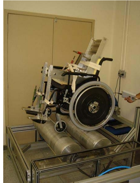
Figura 39 – Cadeira em teste durante a medição de aceleração.
