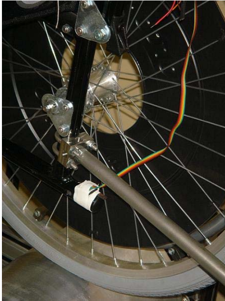
Figura 38 – Posicionamento do acelerômetro na estrutura da cadeira.
