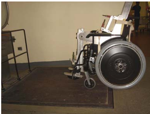
Figura 33 – Pesagem da carga aplicada nas rodas dianteiras
