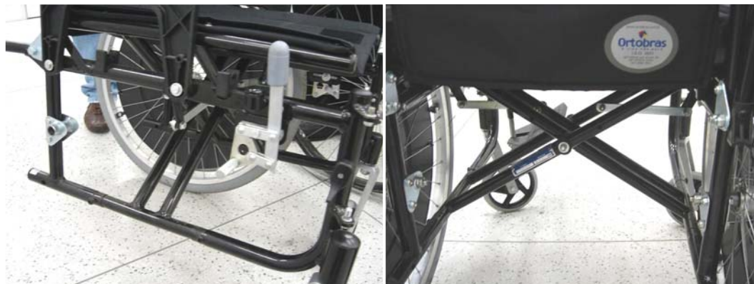
Figura 29 – Detalhes da cadeira de rodas utilizada para ensaio.
