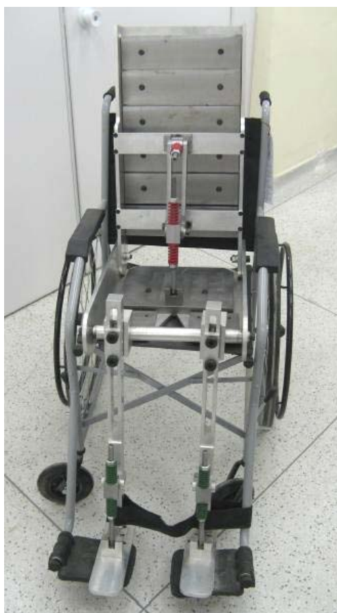
Figura 30 – Boneco de teste de 75Kg (obs.: a cadeira não é a utilizada no ensaio.)
