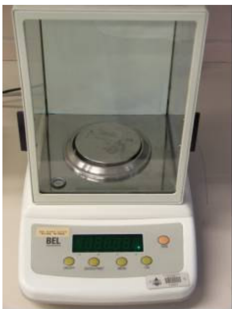
Figura 2 - Balança utilizada para pesar os potes coletores e as glândulas salivares
