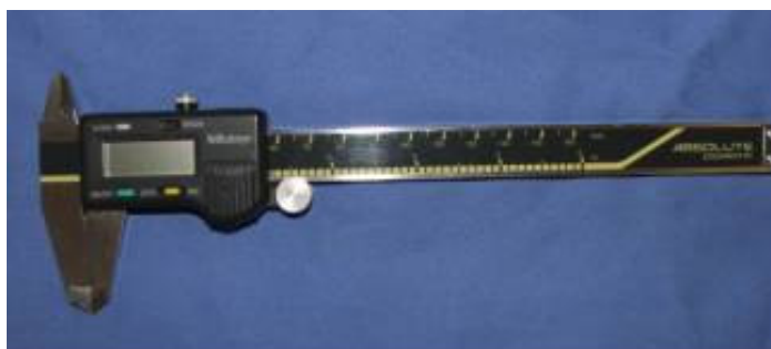
Figura 5 – Paquímetro digital utilizado para medir as glândulas
