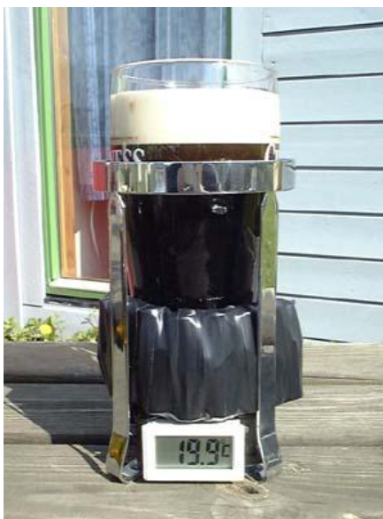
Figura 6-2 Aplicação de módulo de Peltier em cooler portátil
