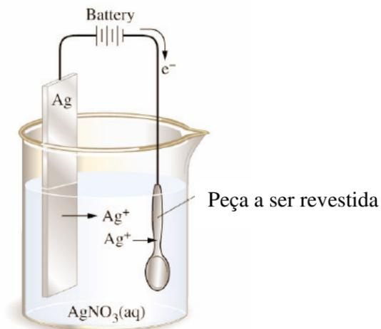
Figura 2.2 - Ilustração do princípio de um processo de eletrodeposição
