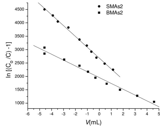
Figura 4.19 – Curva de  $\ln [(C_o / C) - 1]$  versus  $V(\text{mL})$  do modelo de Thomas para adsorção de íons  $\text{Zn}^{2+}$  no efluente pelo BMA2 e SMA2
