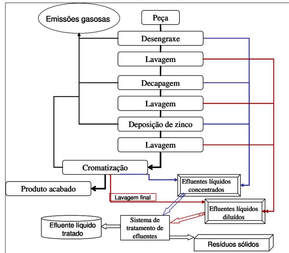
Figura 2.3 - Fluxograma do processo de zincagem típico e geração dos poluentes
