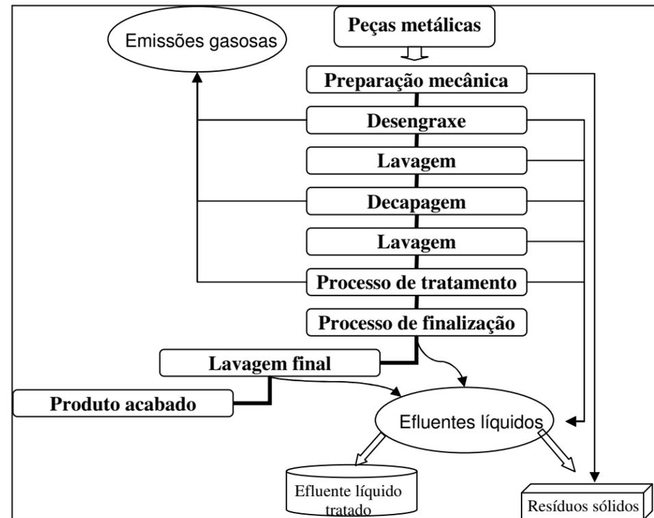
Figura 2.1 - Pontos de geração de poluentes em processo típico de galvanoplastia
