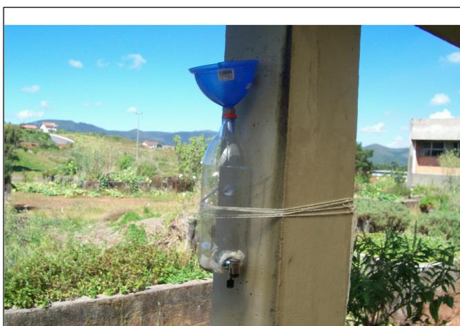
Figura 4.1 - Recipiente coletor de água de chuva instalado no ICEB/UFOP
