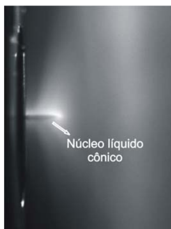
Figura 2.7 Foto do núcleo líquido cônico da Serie RUN3, ensaio 7404500, Vieira (2005).
