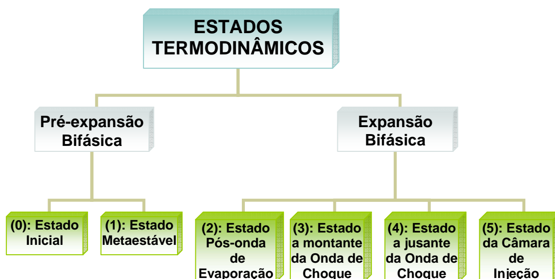
Figura 2.1 Organograma da divisão dos Estados Termodinâmicos que envolvem o fenômeno.
