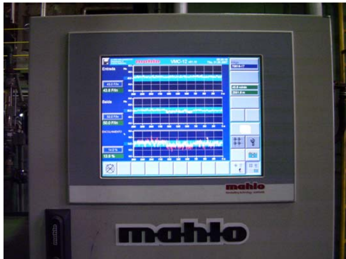
FIGURA 23 - Display com as leituras de número de tramas, percentual de encolhimento, velocidade da máquina, etc.
