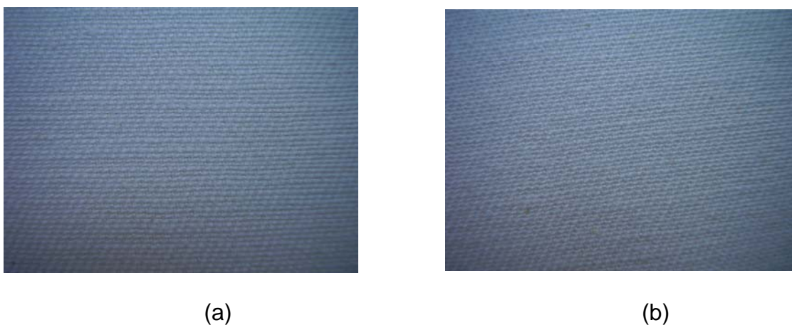
FIGURA 43 - Tecido sarja tinto, (a) antes e (b) depois da sanforização.
