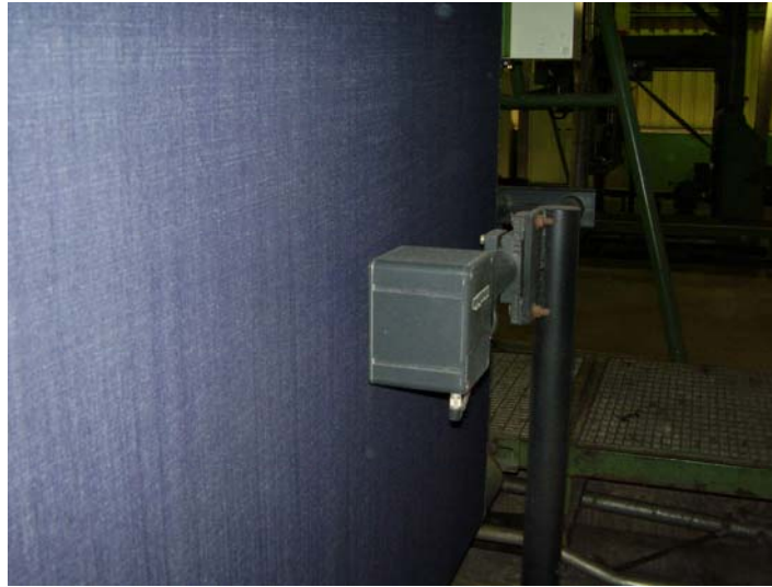
FIGURA 21 – Detalhes dos sensores óticos – emissor e receptor – entrada da sanforizadeira.
