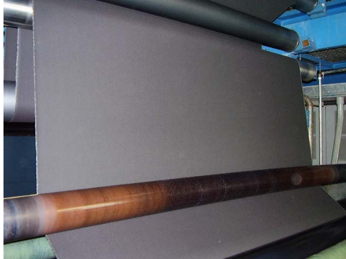
FIGURA 24 - Vista do tecido na saída do fouldard de tingimento.
