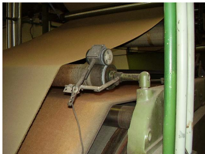
FIGURA 20 – Encoder localizado na saída da sanforizadeira.
