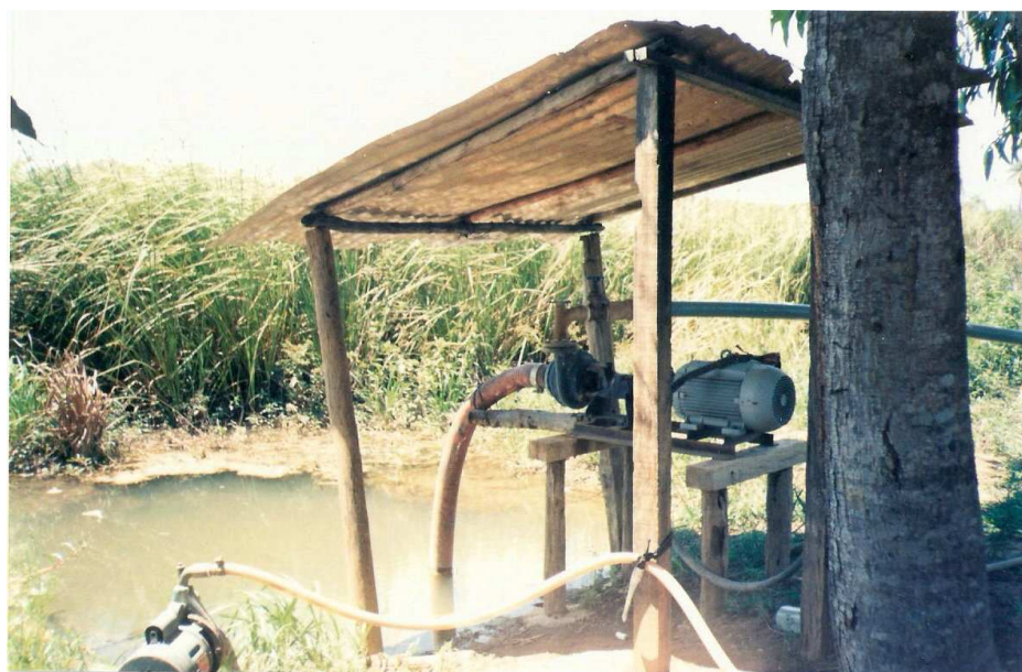
Foto 16: Comunidade de Lagoa da Tiririca - Montes Claros/MG: bomba de sucção desativada instalada em uma propriedade empresarial. A precariedade da forma de se explorar água da lagoa é uma característica evidenciada no local. Ao fundo, a vegetação que dá nome a comunidade e a lagoa. Autor: AFONSO, P.C.S., jan/2002.
