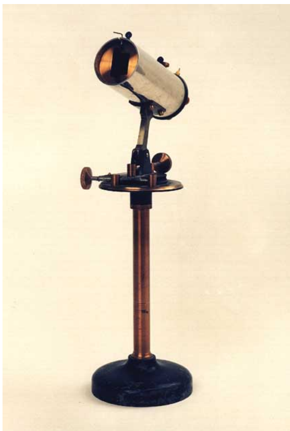
Figura 5.2: Fotografia do pireliômetro absoluto desenvolvido por Knut Ångström. Fonte: Adaptado de www.angstrom.uu.se
