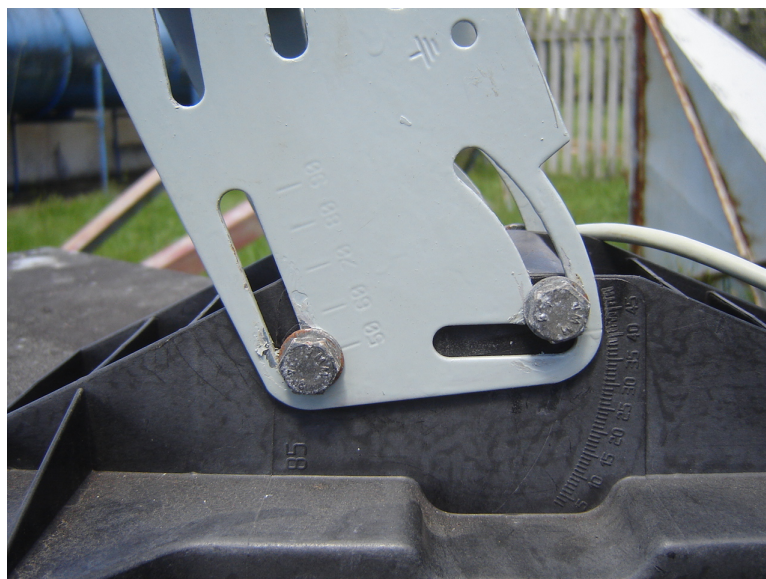
Figura 5.13: Sistema de ajuste angular do conjunto formado pelo motor e anela de sombra rotativo. Este ajuste permite operar o radiômetro em qualquer latitude e declinação solar.
