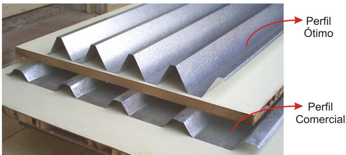
Figura 8.1: Amostras de telhas de perfil ótimo e de perfil comercial para ensaios futuros.
