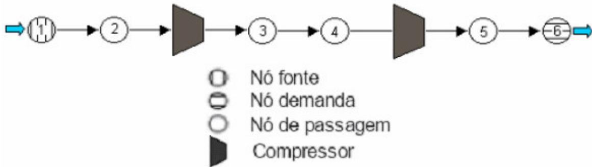
**Figura 01:** Exemplo de rede em cano-de-revólver
