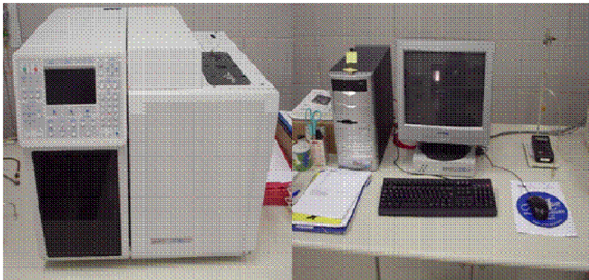
Figura 12 - Cromatógrafo a gás com detector de DNP instalado no laboratório de Recursos Hídricos da UNAERP
