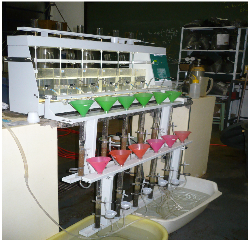
Figura 16: Fotografia do equipamento estático do tipo jarreste em operação de ensaios de ciclo completo com filtros de areia e colunas de adsorção em CAG.
