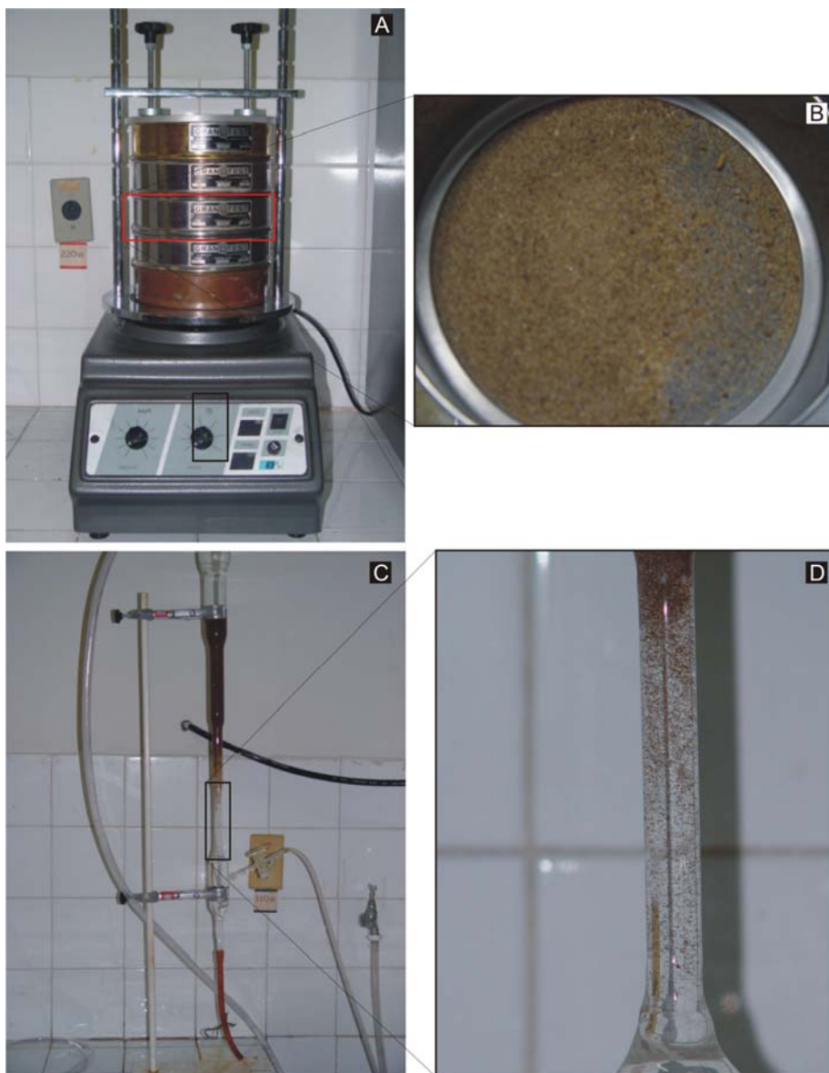
Figura 4. A) Peneiramento de amostras fração areia nos intervalos granulométricos 0,250-0,125mm e 0,125-0,062mm, B) Grãos retidos correspondentes ao primeiro intervalo granulométrico, C) Concentração de minerais pesados por fluxo de água ascendente em elutriador e D) Grãos de maior densidade descem para a base do elutriador, enquanto os de menor ficam em suspensão, conforme mostrado no detalhe do equipamento.
