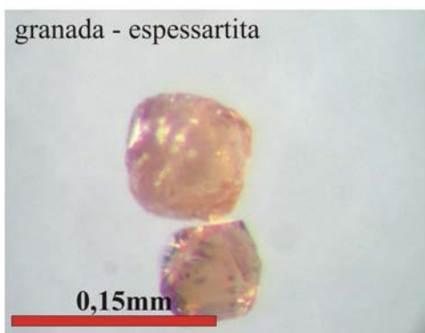
Figura 31. Minerais pesados transparentes encontrados nas unidades estudadas e suas respectivas assinaturas difratométricas. Andalusita (An), granada (Kn – knorringita, Am – almandina e Esp – espessartita) e Ca corresponde à reflexão da caulinita
