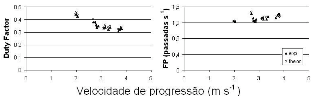
Figura 4.2 FP e DF calculados pelo presente modelo (equação 4.2, theor) e determinados experimentalmente (exp) em diferentes velocidades de progressão.
