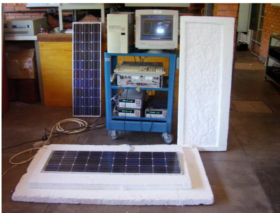
Figura 5.2 – Equipamentos utilizados no ensaio de um módulo sem iluminação.
