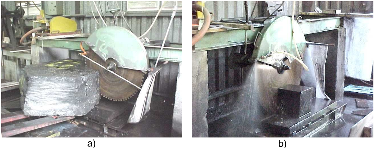
Figura A1.7 - a) Serra de grande porte utilizada para o desmembramento dos blocos de carvão amostrados; b) Corte final em cubo com lado de 30cm.
