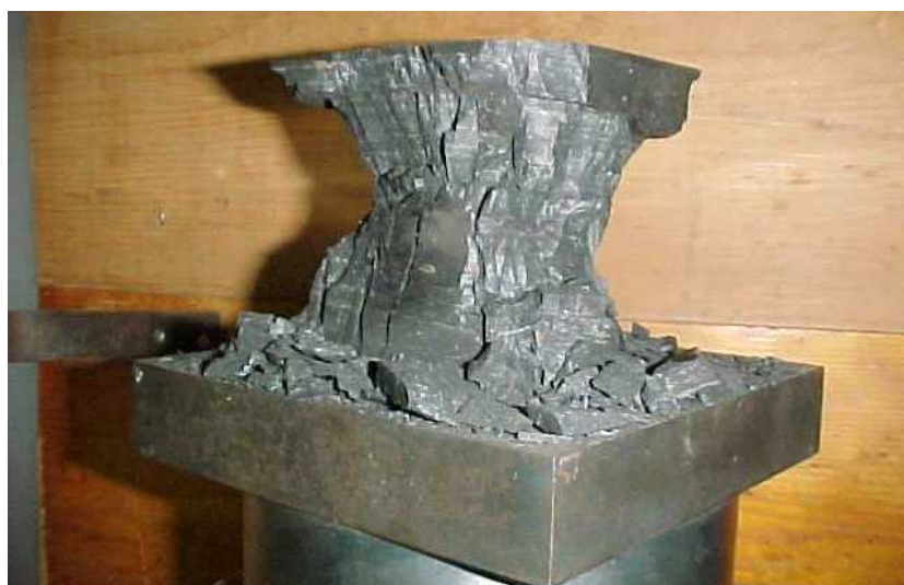
Figura A1.18 - Detalhe de ruptura bipiramidal em corpo-de-prova com L = 10\text{cm} .
