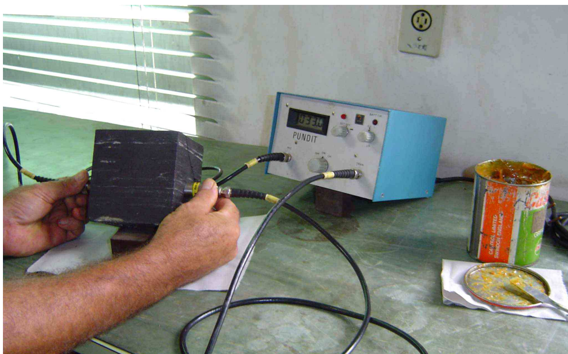
Figura A1.11b - Equipamento PUNDIT utilizado para a medição da velocidade ultra-sônica. No detalhe, determinação da velocidade da onda P na direção da largura do corpo-de-prova utilizando geofone com freqüência de 200kHz - direção de propagação da onda paralela aos planos de estratificação da camada de carvão.
