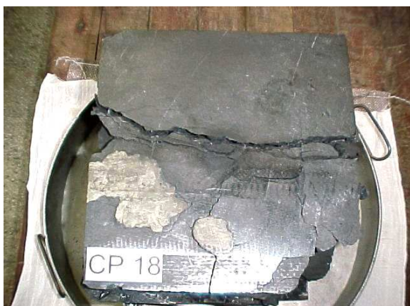
Figura A1.17 - a) Nódulos de pirita observados no topo do corpo-de-prova ( L = 27\text{cm} ); b) Nódulos de pirita observados na face lateral do corpo-de-prova ( L = 11\text{cm} ).
