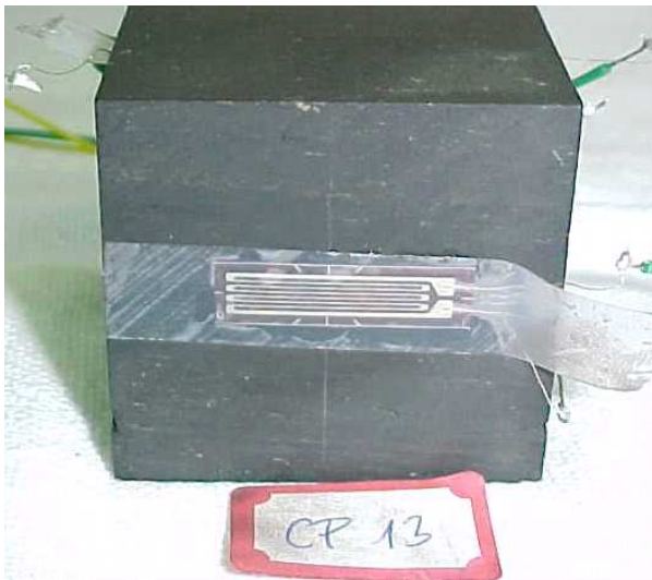
Figura A1.14 - Detalhe da instrumentação ("strain gages") utilizada para a medição de deformações (a) transversais e (b) axiais em corpo-de-prova com lado igual a 5cm.
