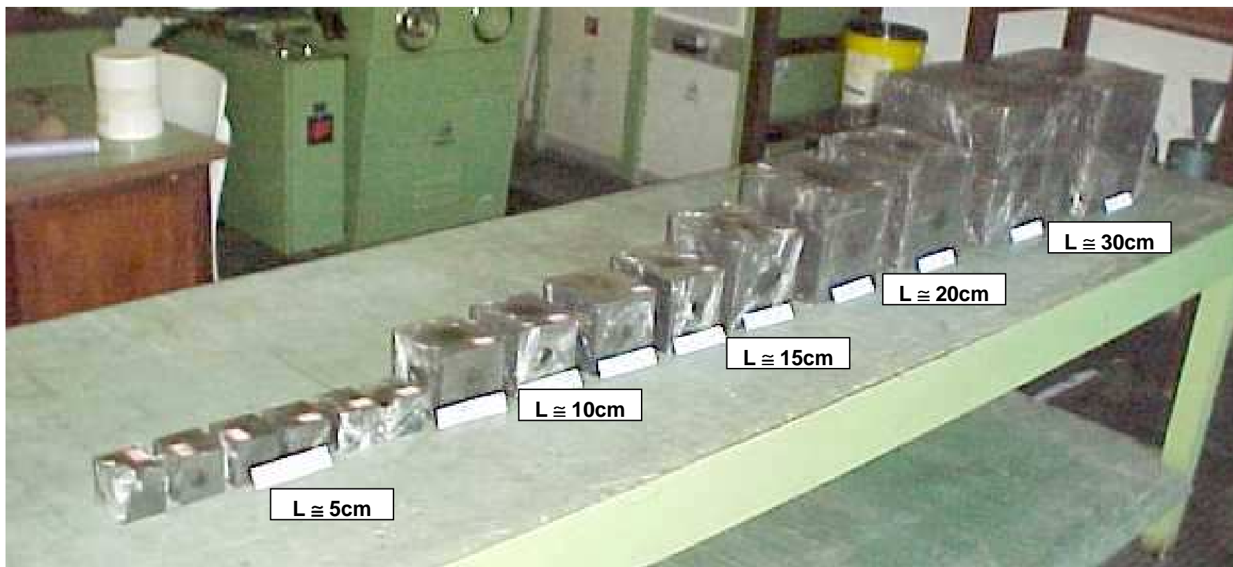
Figura A1.12 - Corpos-de-prova cúbicos de carvão da camada Bonito da Mina Fontanella, com a dimensão do lado (L) variando entre 5cm e 30cm, prontos para ensaio de compressão uniaxial.
