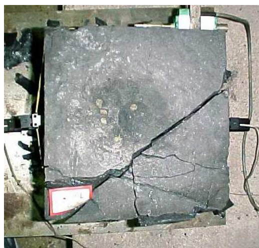
Figura A1.19 - a) Detalhe de fratura na base do corpo-de-prova, paralela à direção de carregamento; b) Superfície de ruptura sobre a fratura pré-existente (corpo-de-prova com L = 27\text{cm} ).
