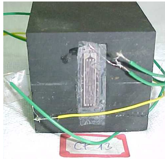
Figura A1.14 - Detalhe da instrumentação ("strain gages") utilizada para a medição de deformações (a) transversais e (b) axiais em corpo-de-prova com lado igual a 5cm.
