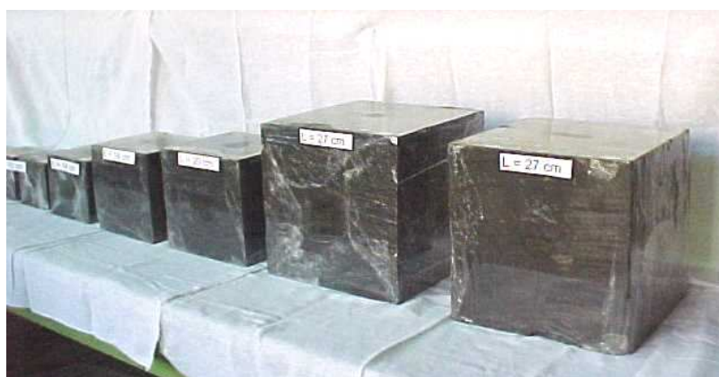
Figura 4.2 - Corpos-de-prova cúbicos utilizados nos estudos do efeito escala no carvão da camada Bonito, da Mina Fontanella.
