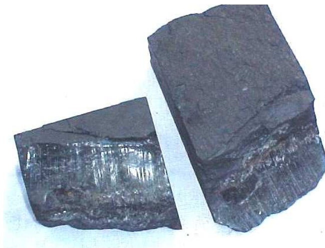
Figura A1.10 - Fratura tipo "slikenside" presente nas amostras coletadas para ensaios em laboratório.
