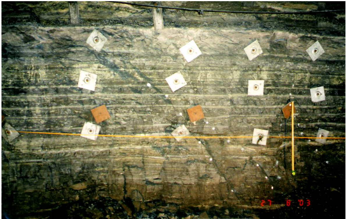
Figura 4.23 - No centro, a linha horizontal de referência (em amarelo) para a determinação da distância aparente entre as fraturas. Notar detalhe da marcação das fraturas (pontilhado branco) para facilitar a medição da orientação e características das fraturas.
