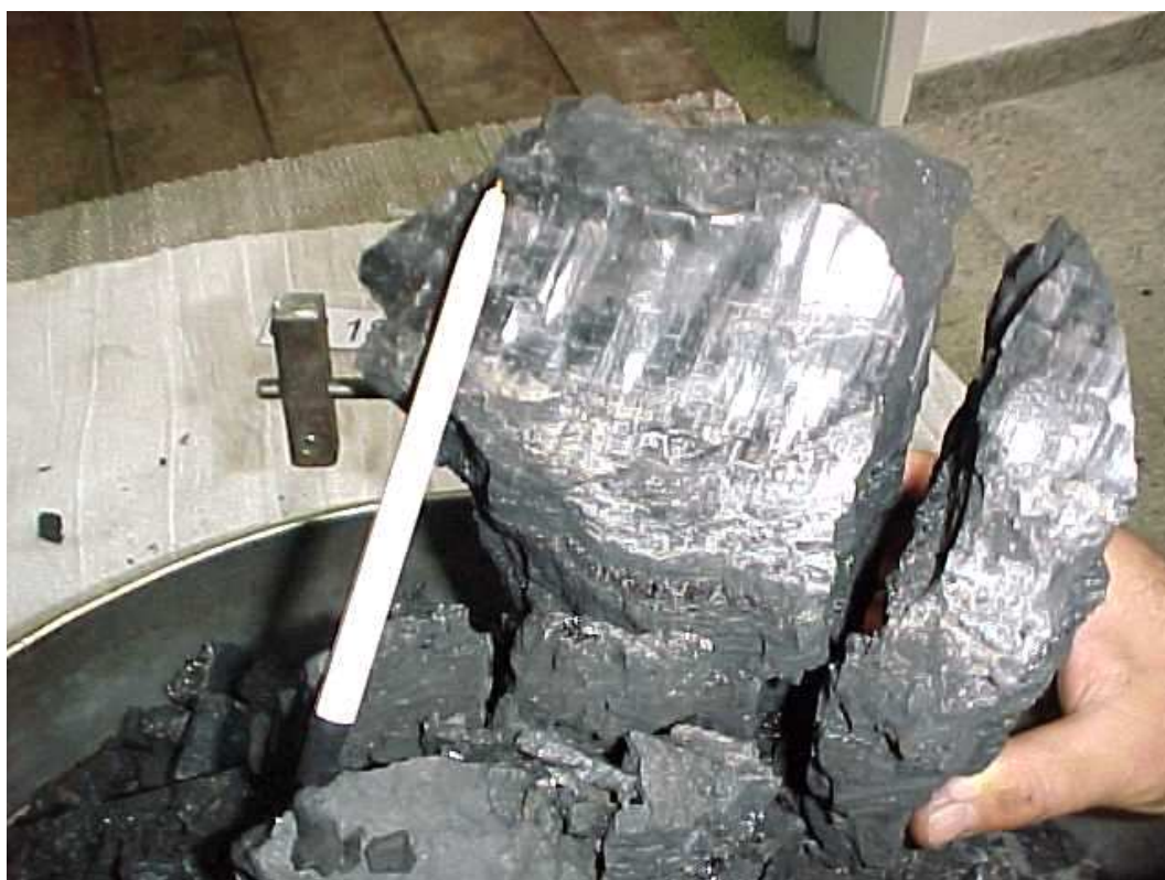
Figura A1.21 - Detalhe da superfície de ruptura sobre "slikenside", em corpo-de-prova com lado igual a 27cm.
