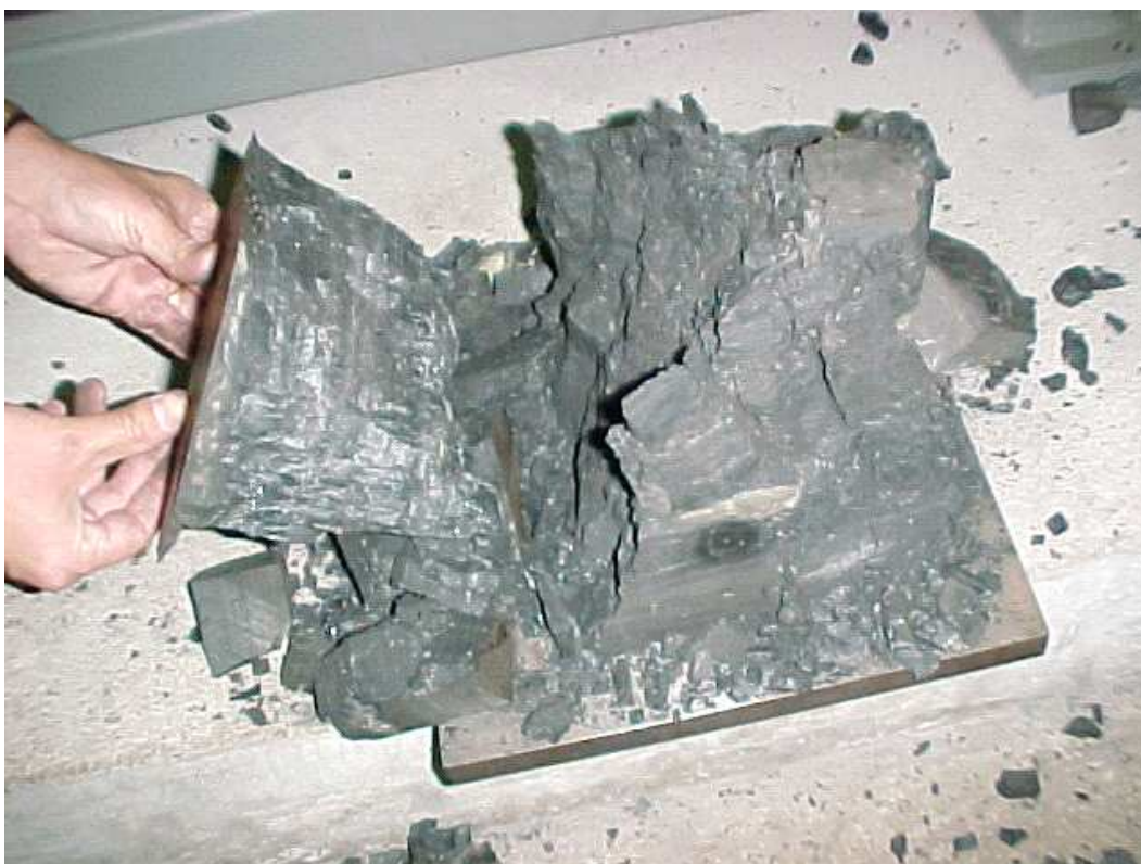
Figura A1.20 - Detalhe da superfície de ruptura por cisalhamento em corpo-de-prova com lado igual a 20cm.
