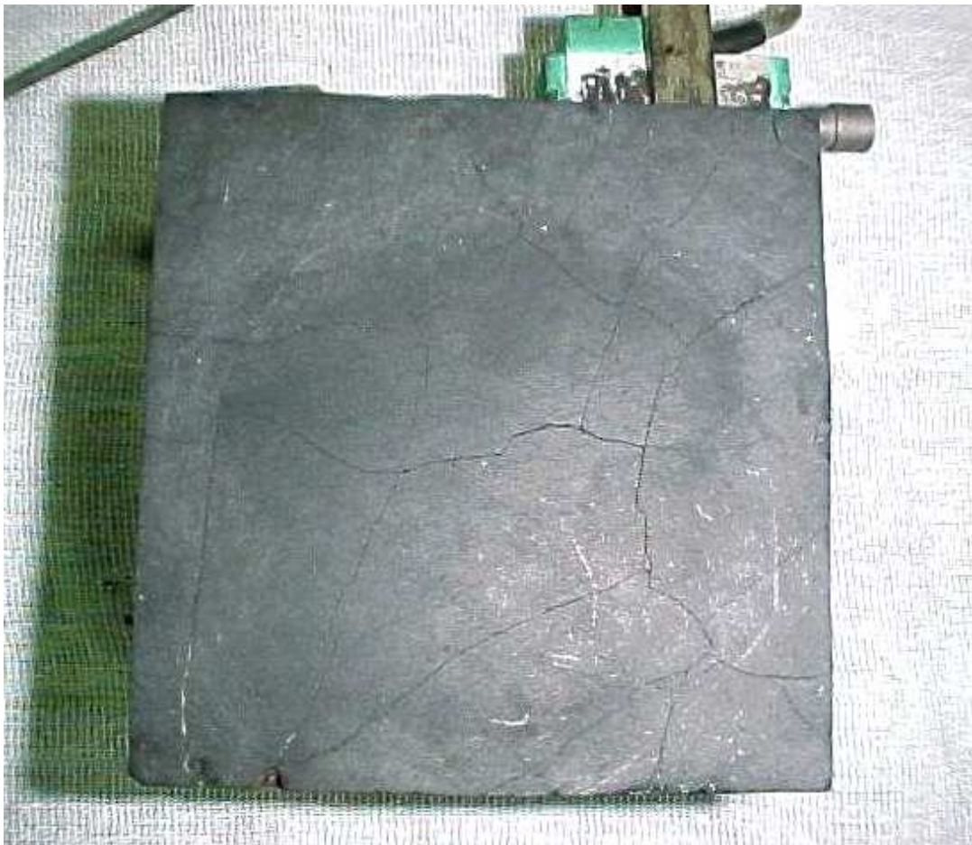
Figura A1.16 - Detalhe das fraturas observadas no topo do corpo-de-prova ( L = 10\text{cm} ).
