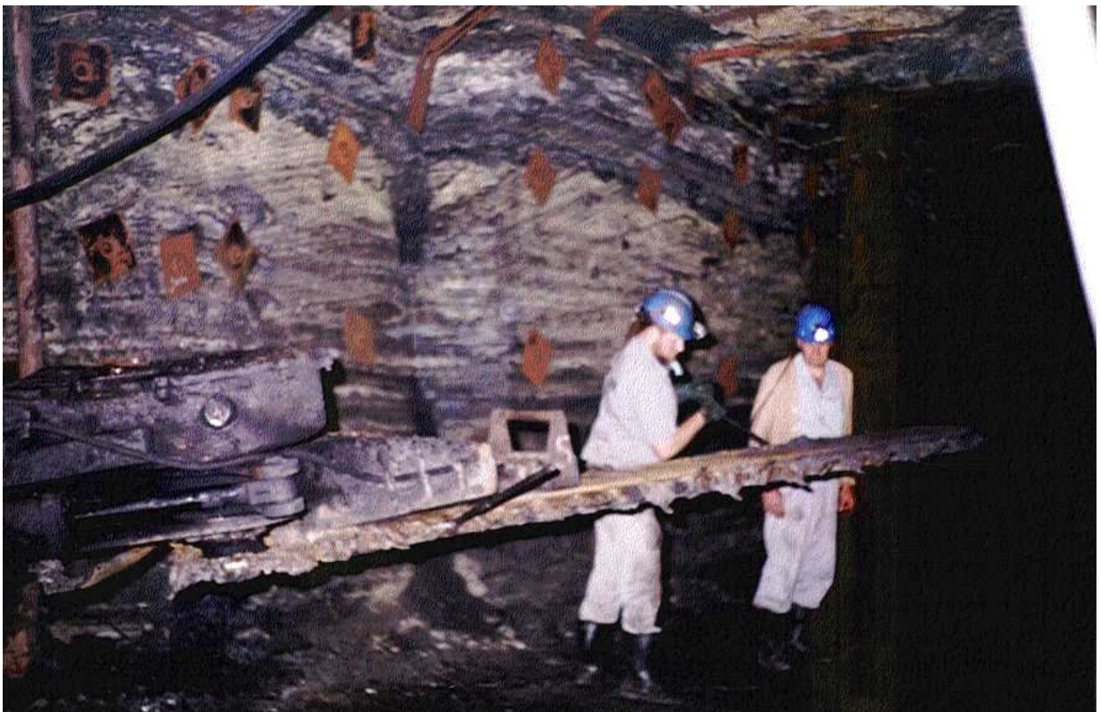
Figura A1.2 - Cortadeira universal utilizada para o corte do carvão na Mina Fontanella.
