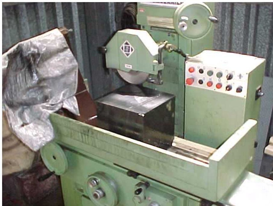
Figura A1.8 - Retífica de superfícies planas utilizada para o acabamento das faces de aplicação das cargas.
