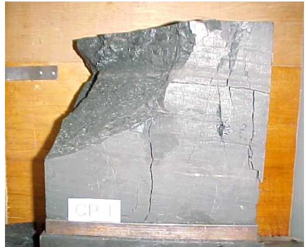
Figura A1.15 - a) Detalhe de fratura inclinada e lâmina de vitrênio ( \pm 2\text{mm} ) na face lateral de corpo-de-prova com L = 30\text{cm} ; b) Vista do plano de ruptura passando pela fratura pré-existente.
