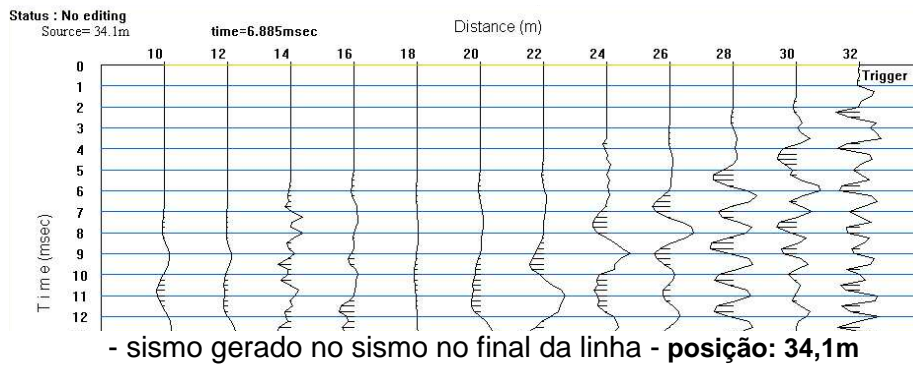
Figura 4.38a - Técnica de perfilagem - Sismogramas obtidos na linha 1 do Ponto 3, na Mina Fontanella. Linha com 12 geofones. Geração do sismo no início da linha (a), no meio da linha (b) e no final da linha (c).
