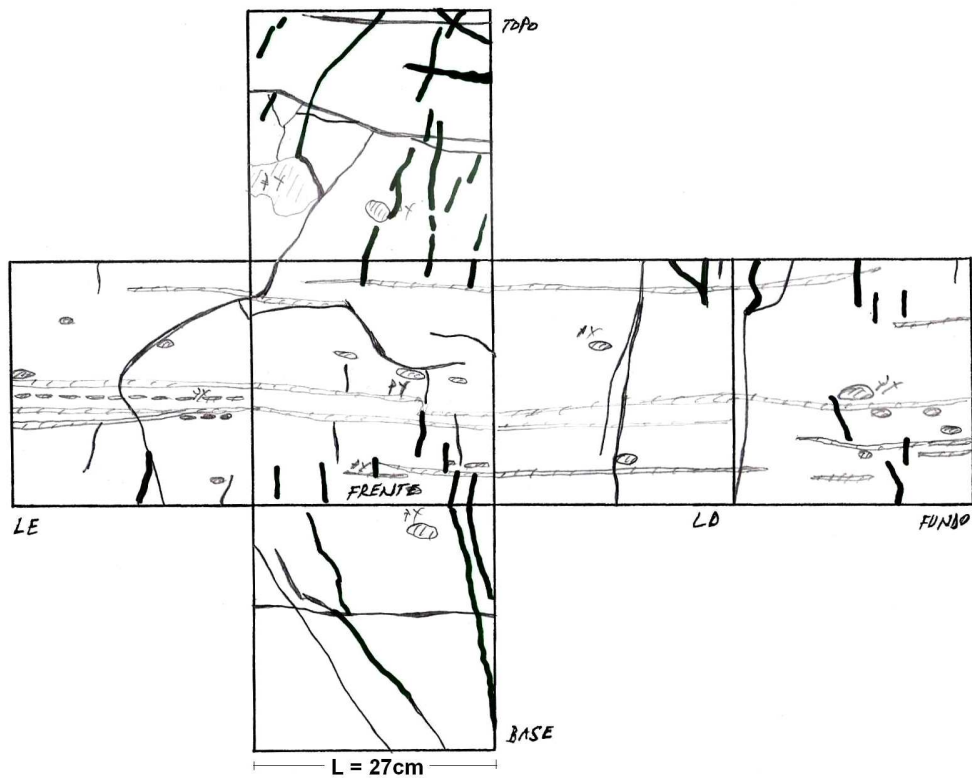
Figura A1.12d - Ilustração das fraturas e inclusões presentes no corpo-de-prova 18 (código de descrição macroscópica: D2---53G1121G3357H4331041H1315133I0J0).
