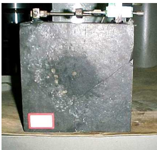
Figura A1.19 - a) Detalhe de fratura na base do corpo-de-prova, paralela à direção de carregamento; b) Superfície de ruptura sobre a fratura pré-existente (corpo-de-prova com L = 27\text{cm} ).
