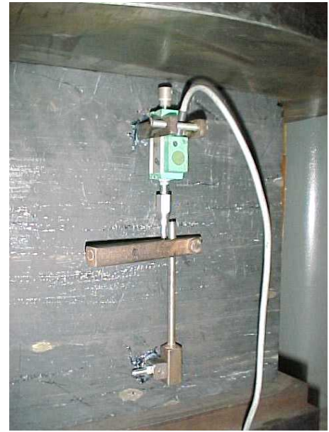
Figura A1.13 - Detalhe da instrumentação (réguas resistivas) utilizada para a medição de deformações (a) transversais e (b) axiais durante a ruptura de corpo-de-prova ( L = 26\text{cm} ).
