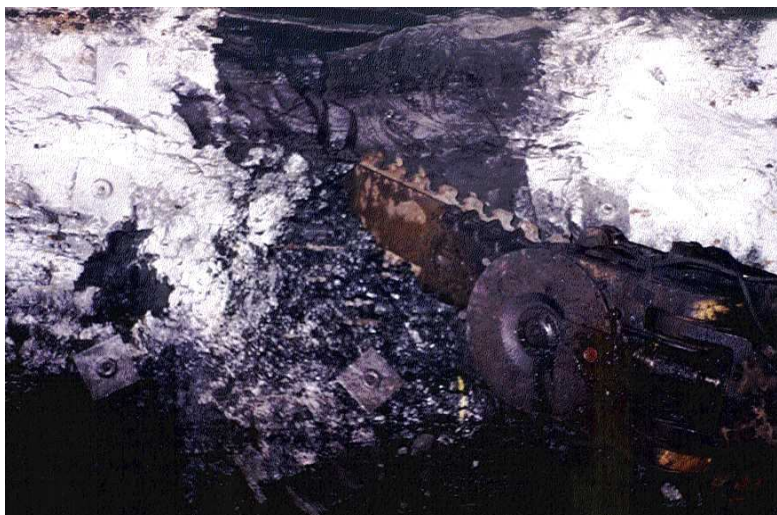
Figura A1.3 - Cortadeira em operação no corte do carvão na camada Bonito.
