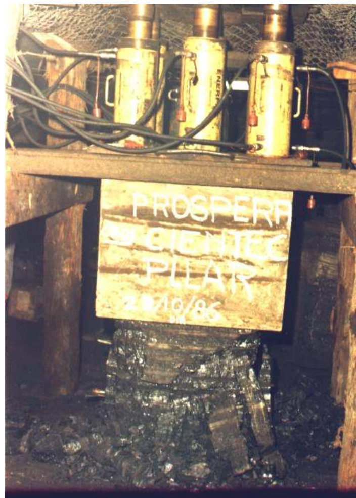
Figura 2.13 - Detalhe do corpo-de-prova ensaiado in situ na metade inferior da camada de carvão Barro Branco, após a ruptura (AGOSTINI et al., 2002).
