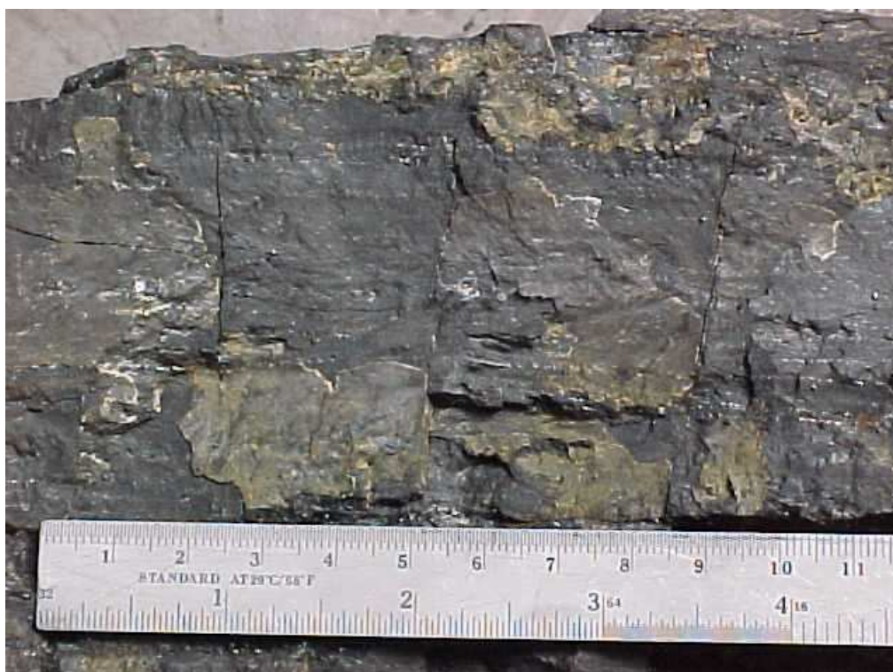
Figura A1.9 - Detalhe das fraturas (cleats) com espaçamento inferior a 10cm, presentes nas amostras do ponto 4.
