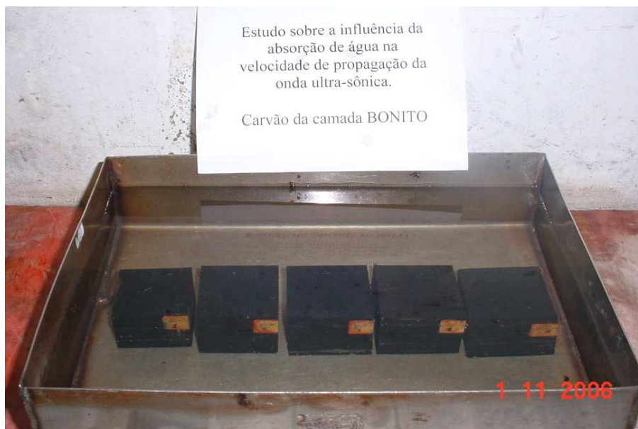
Figura 4.51 - Imersão dos corpos-de-prova de carvão em água à temperatura ambiente, durante o estudo da influência do grau de saturação na velocidade da onda ultra-sônica no carvão da camada Bonito da Mina Fontanella.
