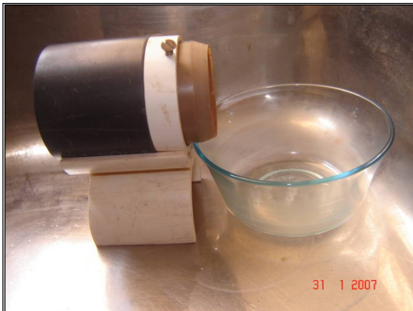
Figura 3.5 - Suporte para colocar a amostra conjunto (anel+amostra+suporte) e pirex.
