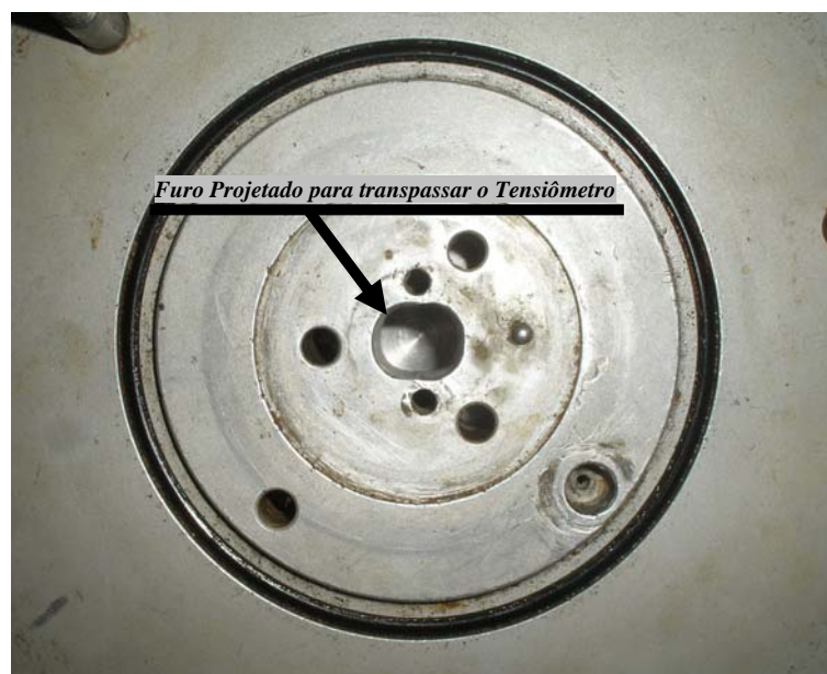
Figura 3.7– Furo na base da câmara de ensaios.
