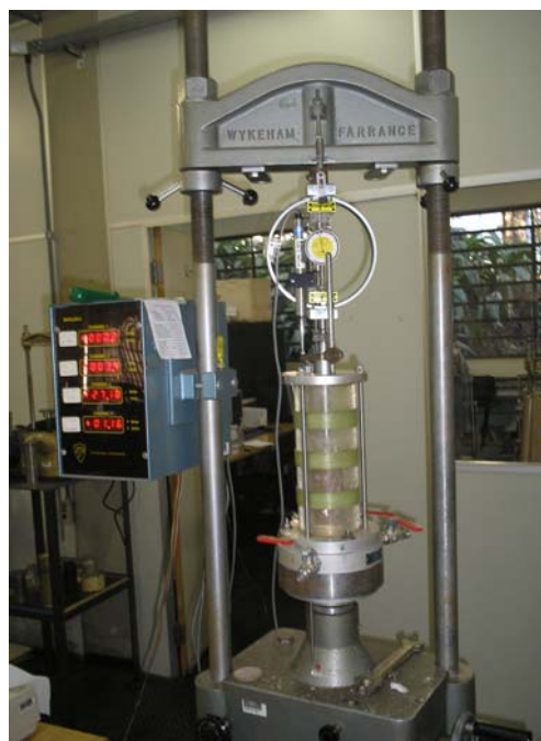
Figura 3.14 – Ensaio de compressão simples montado.
