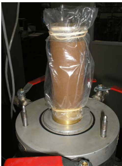
Figura 3.13 – Corpo de prova envolto por plástico para reduzir a perda de umidade para o ambiente.
