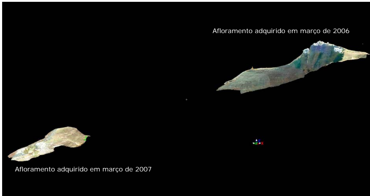
Figura 4-26 – Nuvem de pontos registrada das duas aquisições com tratamento, apresentando como textura a imagem obtida com o Laser Scanner .
