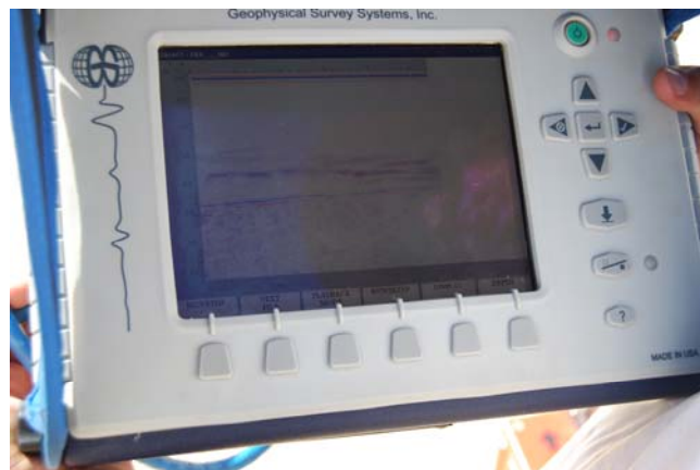
Figura 4-3 – Unidade de controle e visualização do Sistema GPR TerraSIRch SIR System-3000
