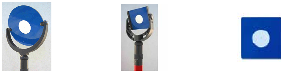
Figura 2-6 – Targets do tipo circular com giro (esquerda), quadrado com giro (centro), e magnético (direita).
