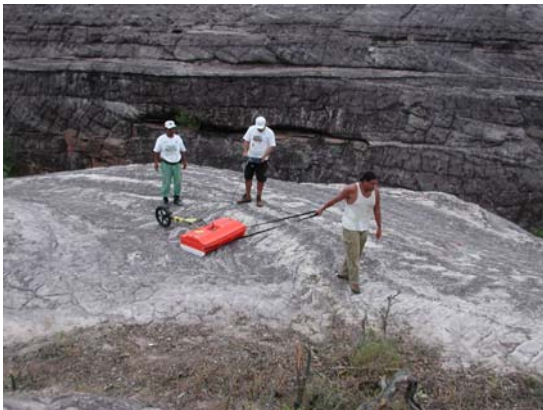
Figura 4-20 – Aquisição de perfil GPR na linha 2 com antena de 100 MHz.
