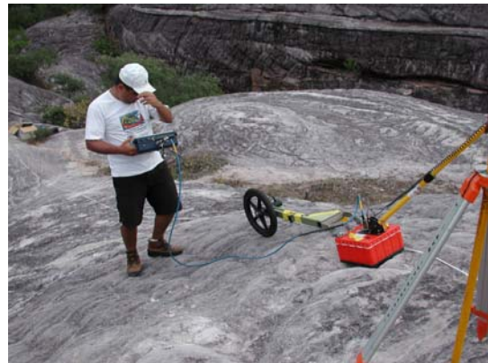
Figura 4-21 – Aquisição de perfil GPR na linha 1 com antena de 400 MHz.
