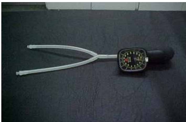
FIGURA 4 – Manômetro de aferição constituído por cateter em Y, mostrador graduado em mmHg e pera de insuflação
