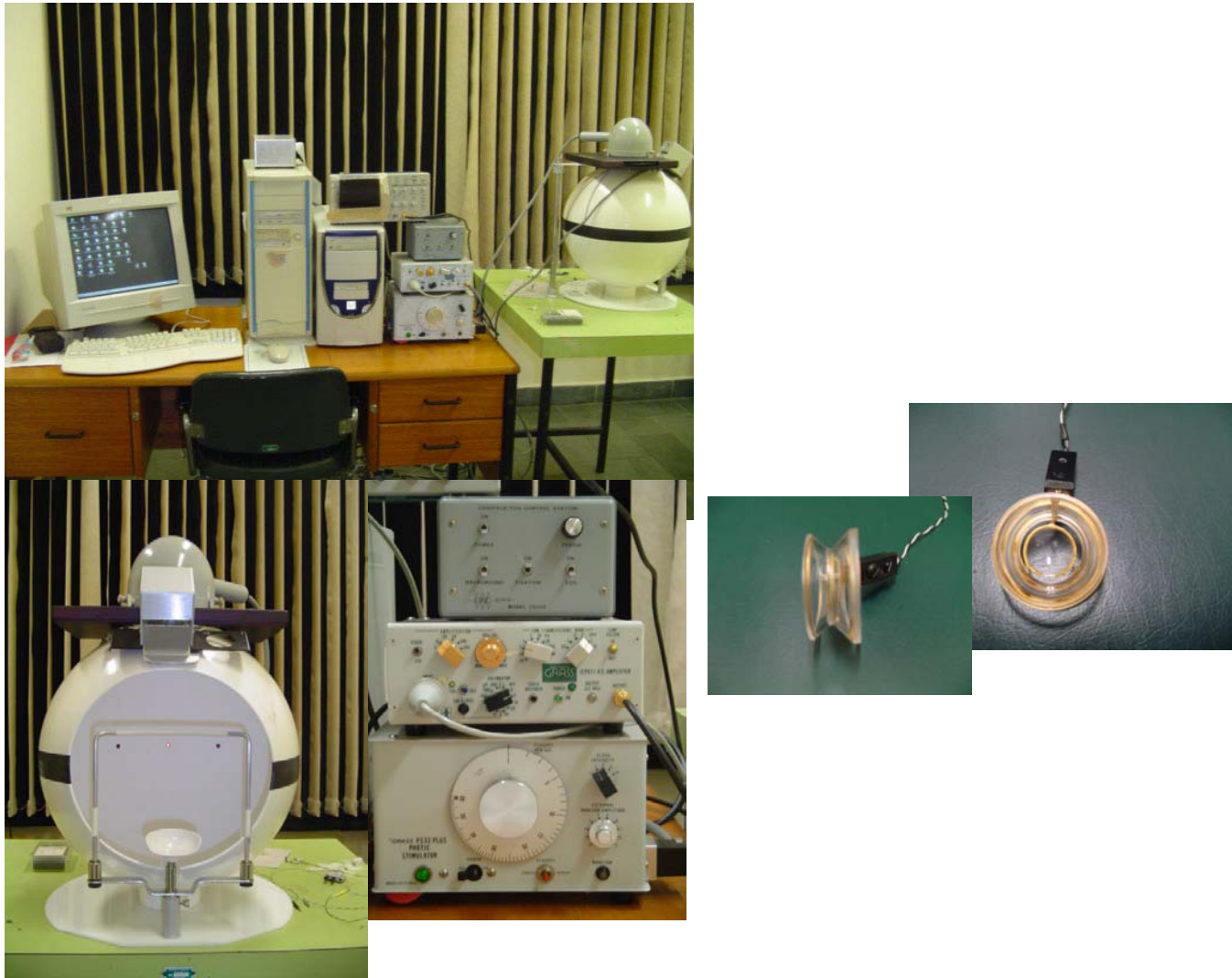
Figura 11: Ilustração dos equipamentos utilizados para a medida do eletrorretinograma de campo total. Na foto superior, à direita, uma visão geral do computador utilizado para o registro das respostas e análise dos dados (esquerda), seqüência de amplificador e estimulador (centro) e a cúpula refletora – Ganzfeld (direita). Nas fotos inferiores, à direita, temos em aumento e com visão frontal o Ganzfeld (esquerda) e a estação contendo o controlador do Ganzfeld (acima), o amplificador com botões para filtragem do sinal (centro) e o fotoestimulador (abaixo). À esquerda temos a visão frontal e lateral da lente-eletrodo utilizada para a captação das respostas retinianas.
