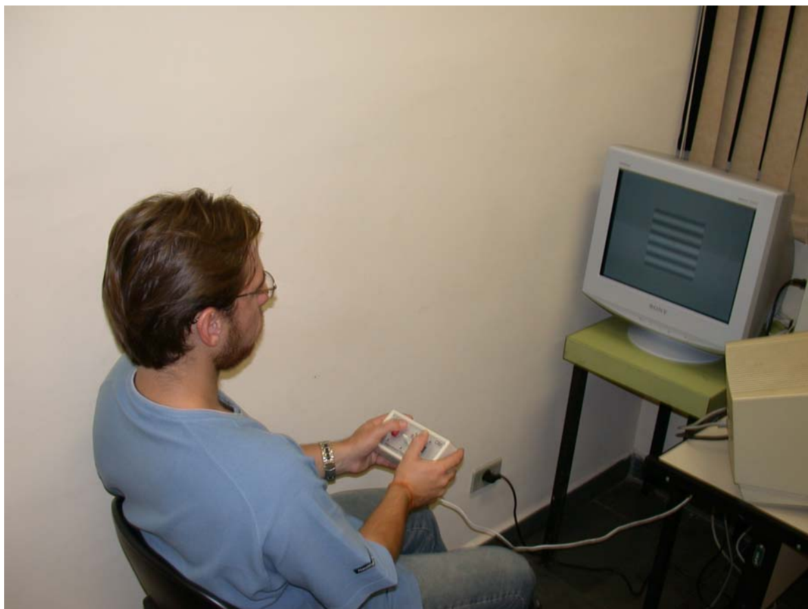
Figura 13: simulação da situação da medida de sensibilidade ao contraste de luminância. O sujeito permanecia sentado há 1 metro de distância do monitor onde eram apresentados os estímulos. Em nossa rotina, o experimentador manipulava a caixa de respostas. Podemos observar no centro do monitor o padrão de ondas senoidais utilizados como estímulos.
