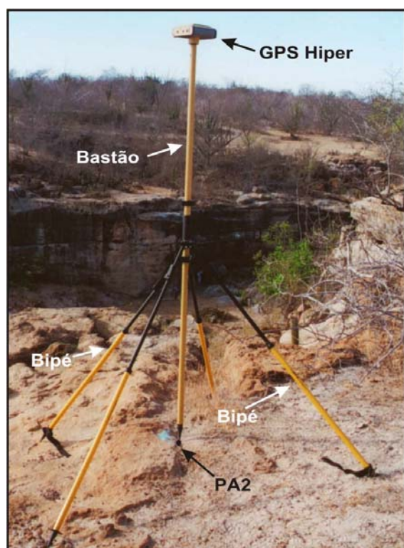
Foto 4.2 – Levantamento estático realizado com GPS Hiper dupla frequência, no ponto de amarração PA2. Localizado no afloramento da Fazenda Currallinho.
