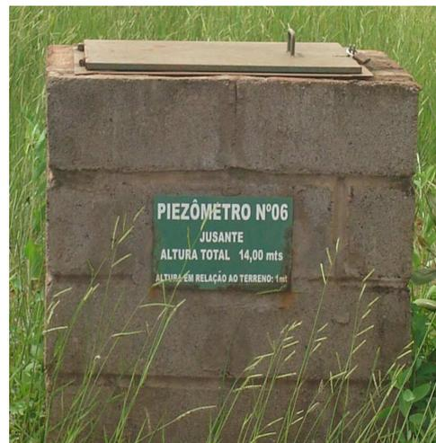
**Figura 4.7** Piezômetros de monitoramento d'água
