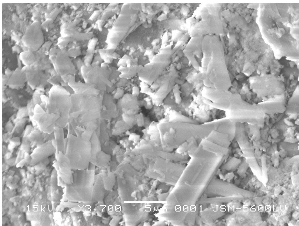
Figura 4.1 – Cristais de gesso produzidos sem controle de pressão e temperatura
