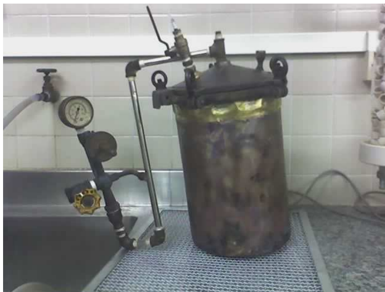
Figura 19 – Reator do tipo autoclave para produção de gesso beta reciclável em escala de bancada
