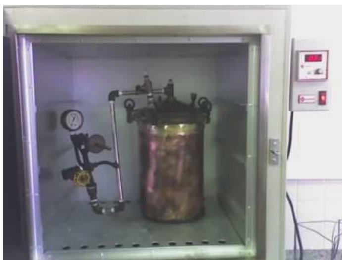
Figura 20 - Estufa com controle digital de temperatura utilizada como fonte de calor para reação de desidratação térmica que ocorre no forno-autoclave
