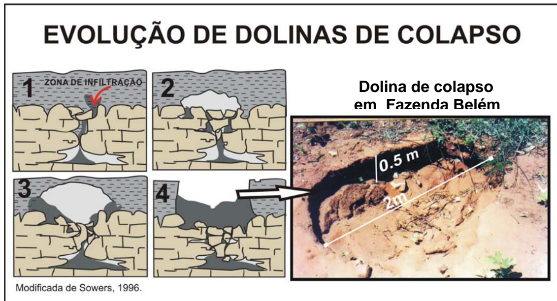
Figura 7.14 – Modelo dos estágios evolutivos de uma dolina de colapso (1 a 4) e a foto de um exemplo real de dolina de colapso em Fazenda Belém.
