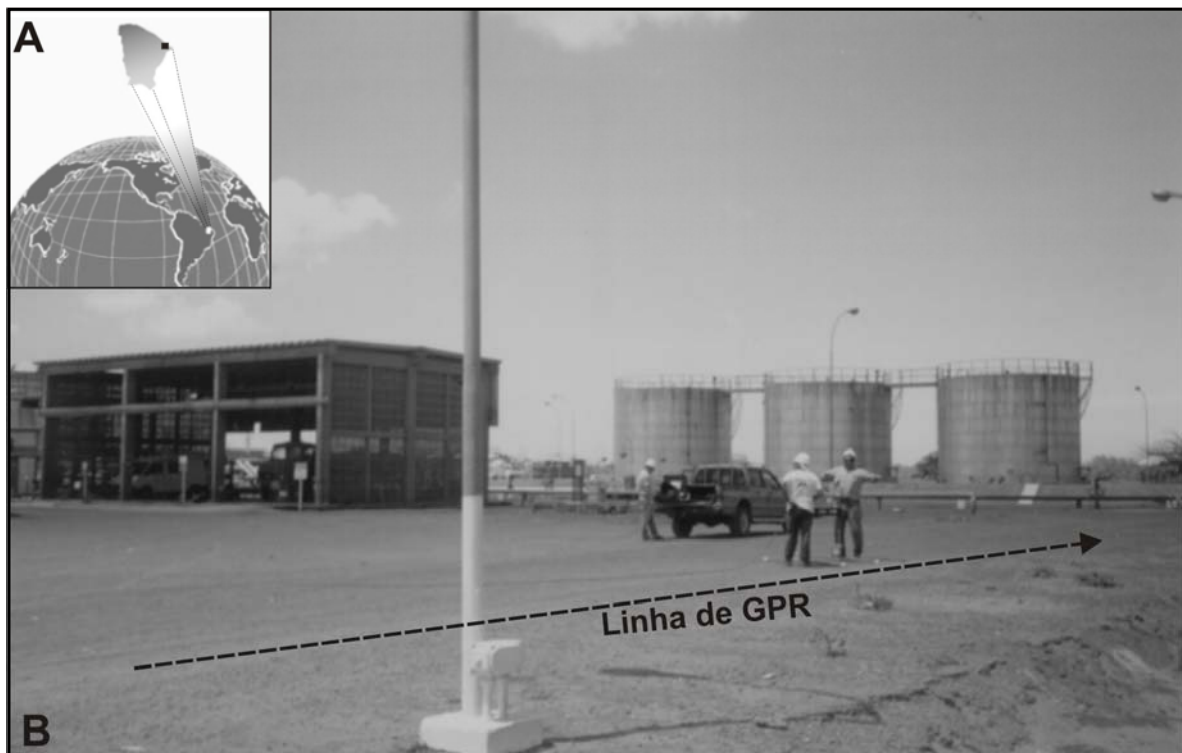
Figura 3.9 - Localização da área do levantamento de GPR (A) e visão local da área industrial da PETROBRAS (B). A linha (200 MHz) foi registrada em solo saturado por água de chuva que ocorreu pouco antes do levantamento.
