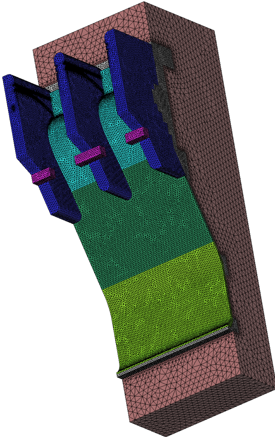
Figura 5.3: Malha da estrutura do vertedouro.
