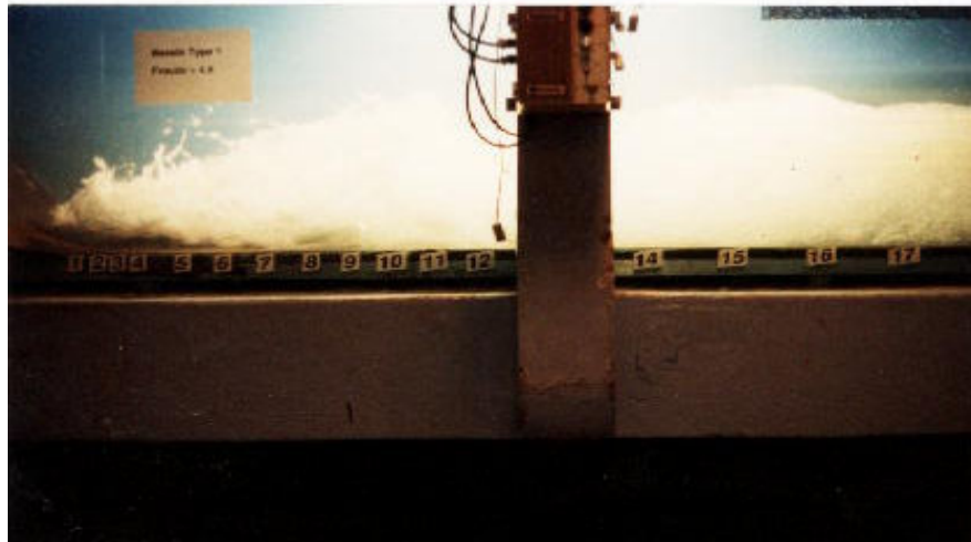
Figura 2.3 – Ressonância hidráulica em um canal com número de Froude ( Fr ) igual a 4,9 – Marques et al (1997).
