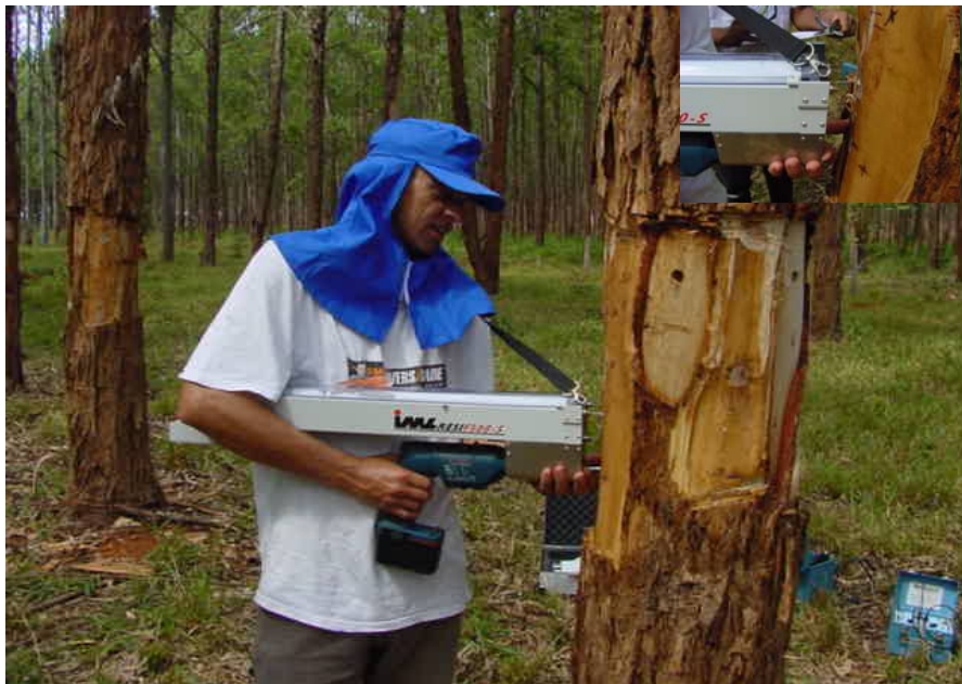
FIGURA 2 Resistógrafo em aplicação para a obtenção de dados de resistência mecânica à penetração da broca na madeira de Eucalyptus .
