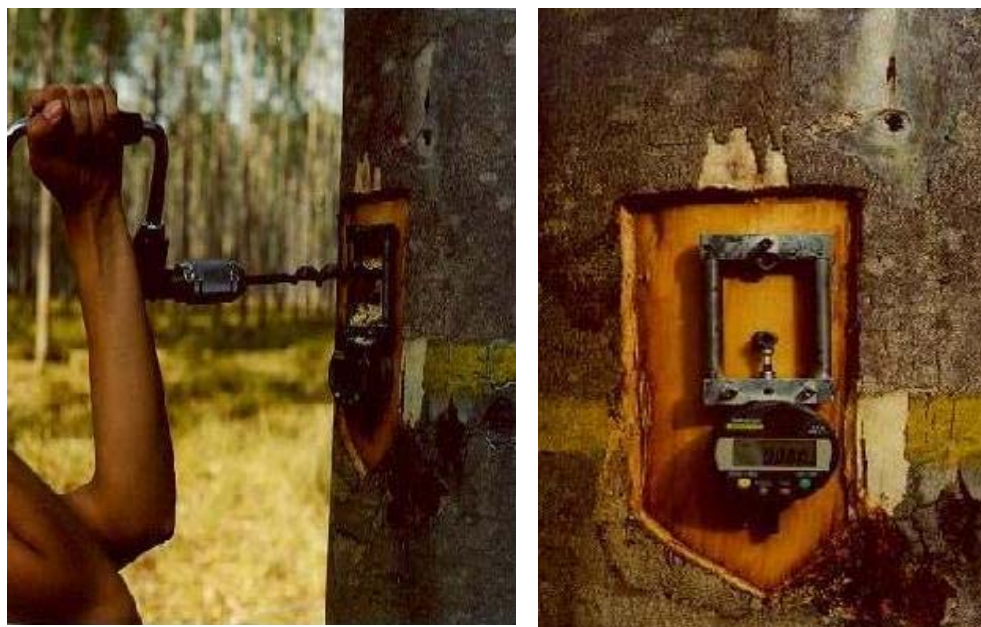
FIGURA 1 Extensômetro em aplicação para a obtenção de dados de deformações residuais longitudinais (DRL) de Eucalyptus .
