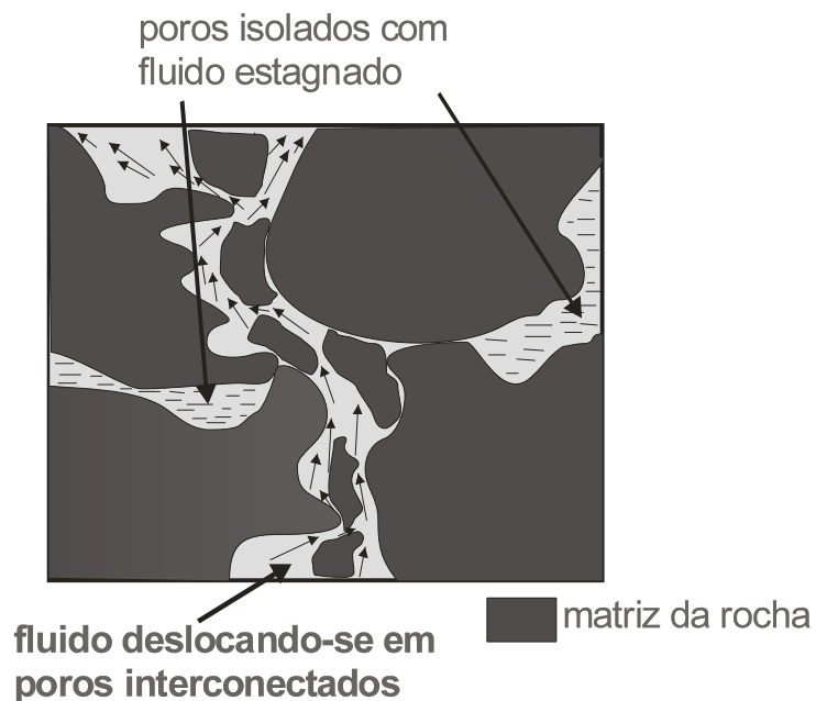
Figura 2.3. Esquema de uma rocha com poros isolados e poros interconectados.
