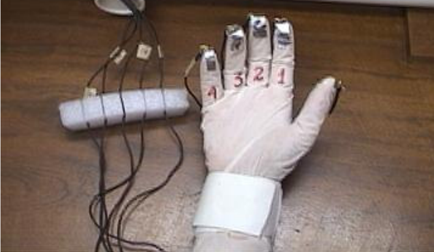
Figura 1: Mão preparada para o registro dos movimentos de oposição dos dedos. Os cabos se conectam, através de uma interface, a um microcomputador programado para registrar o contato entre o polegar e os demais dedos.
