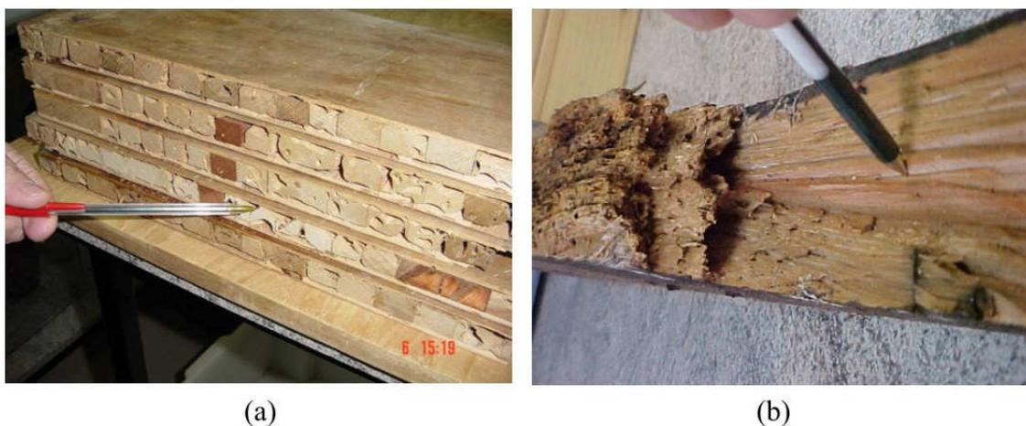
Figura 5: (a) miolo de compensado atacado; (b) estrutura de telhado atacada
