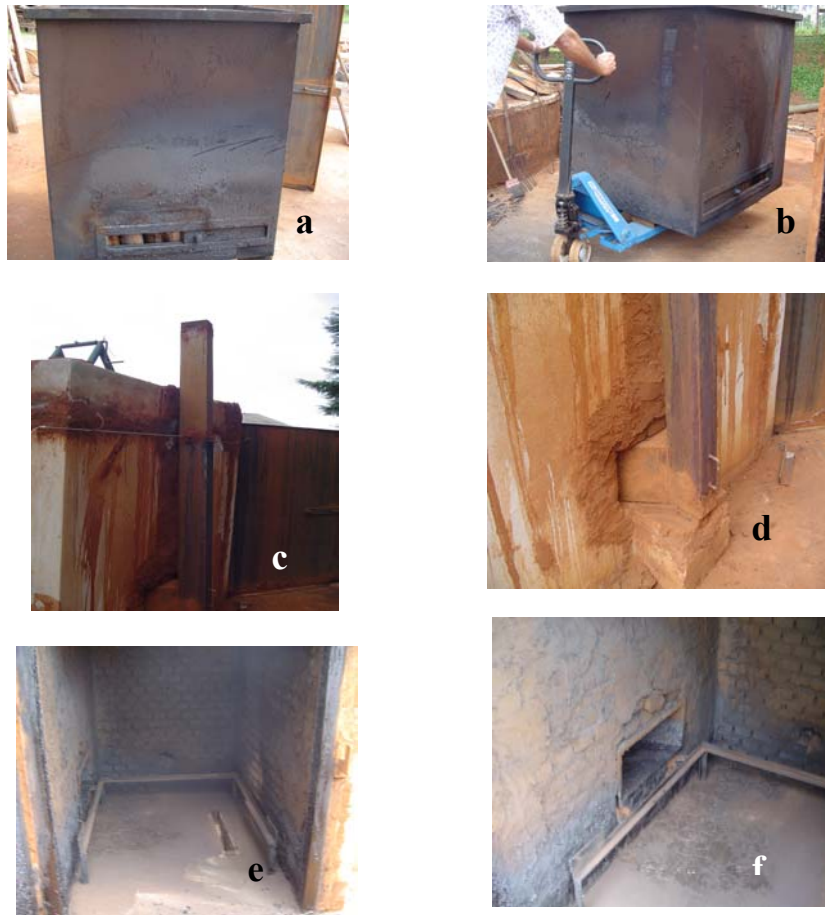
FIGURA 5 (a) unidade de carvoejamento carregada, (b) uso de paleteira para o transporte e colocação na unidade isolante, (c e d) presença de uma chaminé metálica móvel, (e) abertura na entrada de gás na câmara e (f) abertura para a saída dos gases pela chaminé.
