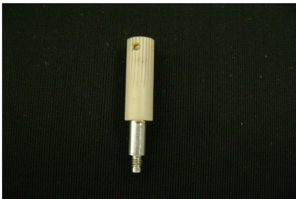
Figura 14 - Condutor de borracha acoplado ao *Smartpeg*.
