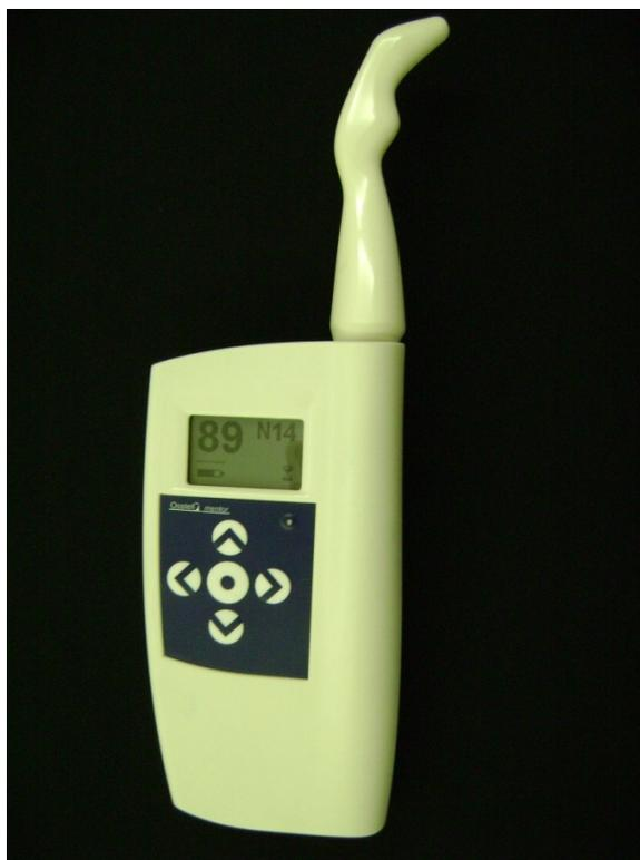
**Figura 7 - Analisador de frequência de ressonância, Osstell Mentor.**
