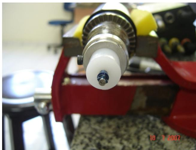
**Figura 10 - Implante instalado no corpo de prova**
