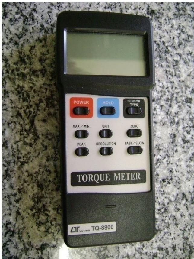
Figura 6 - Torquímetro Lutron, TQ-8800
